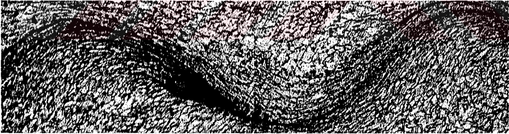
Şekil 2.14 Patlamalı Kaynakta Elde Edilen Dalgalı Ara Yüzey [26]
