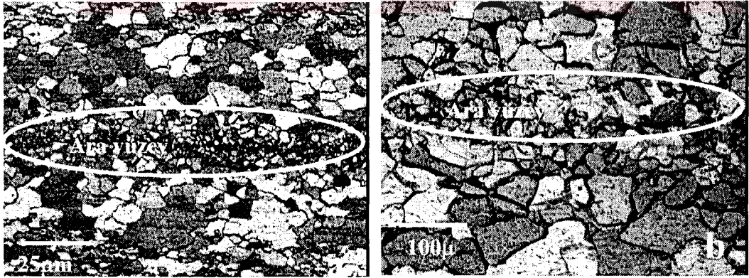
Şekil 4.8 D birleşmesinin ısıtılma işlemi görmüş mikro yapısı a)X50 b)X200
