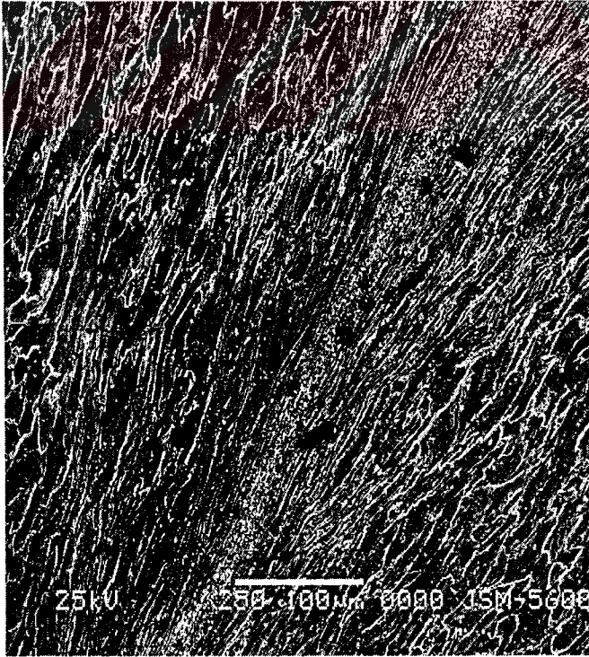
Şekil 4.30 A birleşmesinin ısı işlemsiz SEM görüntüsü
