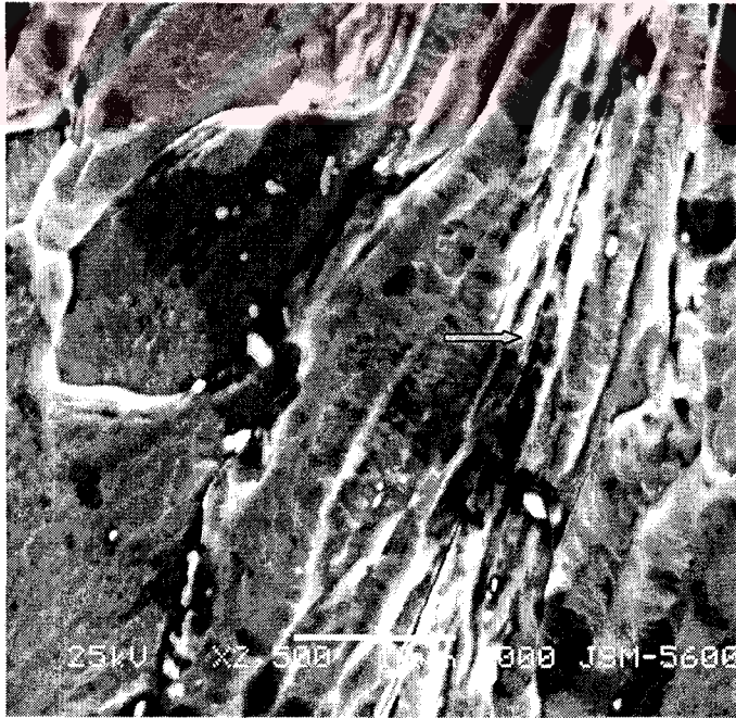
Şekil 4.28 C birleşmesinin ısı işlemsiz SEM görüntüsü
