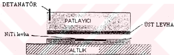
Şekil 2.22. NiTi'nin düşük karbonlu çeliğe paralel patlamalı kaynak düzenlemesi [48]
