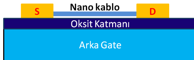
Şekil 6.4 \beta\text{-Ga}_2\text{O}_3 nano kablonun FET gaz sensörü olarak kullanılması
