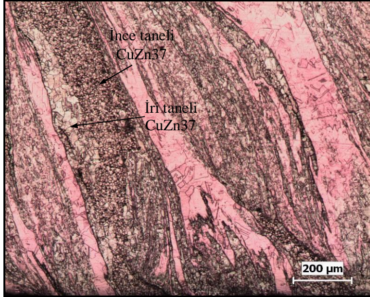
Şekil 6.76. 1000/22 Cu/CuZn37 birleştirme numunesinin kök kısmı
