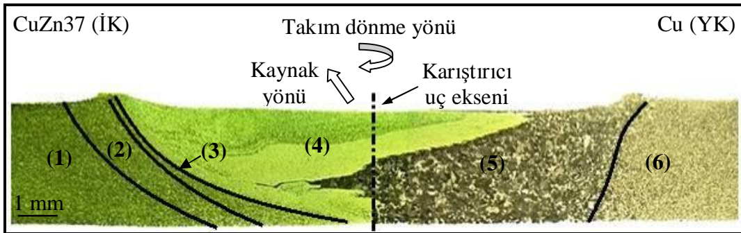
Şekil 6.14. 600/22 CuZn37/Cu birleştirmesinin makroyapı resmi ve farklı mikroyapı bölgelerinin sınıflandırılması; (1) CuZn37 ana metal (İK), (2) CuZn37-ITAB, (3) CuZn37-TMEB, (4) KM, (5) Cu-ITAB, (6) Cu ana metal (YK)
