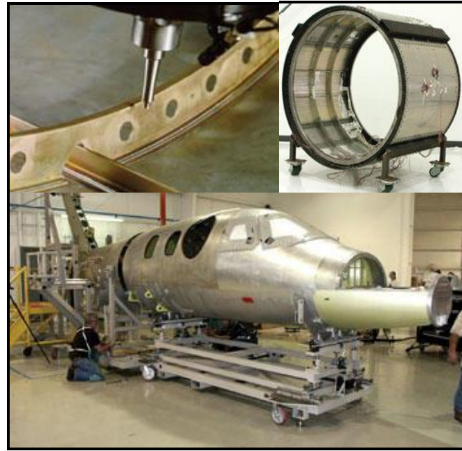
Şekil 3.21. Bir jet uçağının gövdesinin SKK yöntemiyle imal edilme aşamaları
