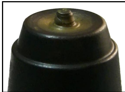
Şekil 6.2. Cu ve CuZn37 levhaların SKK ile birleştirilmeleri sonrasında, takım karıştırıcı uç ve omuz kısmının görünümü
