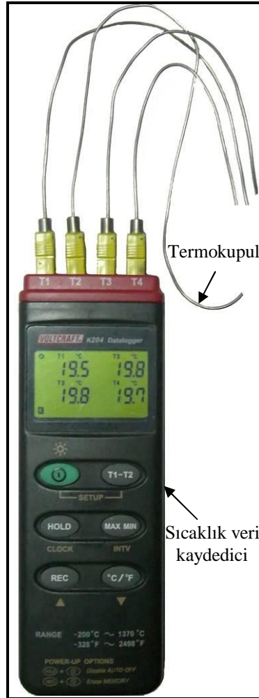
Şekil 5.4. SKK sırasındaki sıcaklıkların ölçümünde kullanılan sıcaklık veri kaydedici ve K-tipi termokupullar
