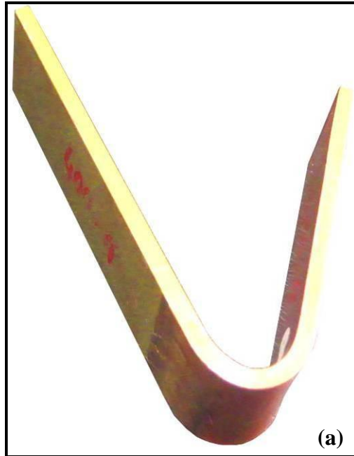
Şekil 6.101. 400/22 Cu/CuZn37 birleştirmesine ait eğme deneyi sonrası; (a) yüzey ve (b) kök eğme numunelerinin görünimleri
