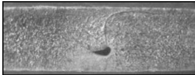
Şekil 4.19. 260 mm/dakika kaynak hızında birleştirilen CuZn30 pirinç levhaların karışım bölgesi içerisindeki tespit edilen boşluğun optik mikroskoptaki görünümü, \times 20 [18]
