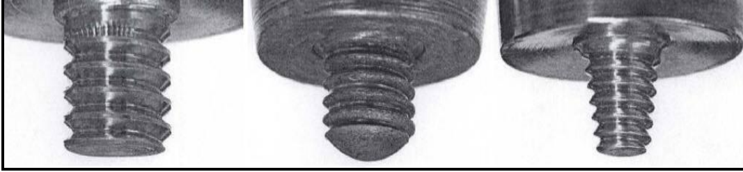
Şekil 3.4. Farklı geometrilerdeki silindirik ve konik karıştırıcı uçlardan yapılmış takım örnekleri [50]
