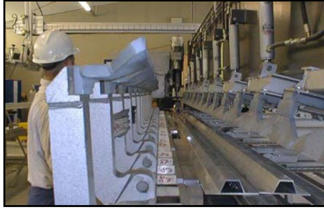
Şekil 3.20. Güverte inşasında kullanılan, ekstrüzyon ürünü alüminyum panellerin SKK yöntemiyle birleştirilmesi
