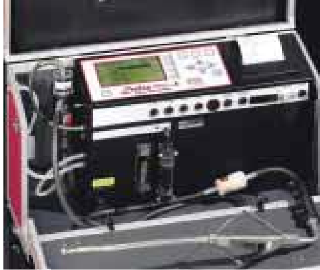
Şekil 4.23. Emisyon ölçüm cihazı (MRU Delta 1600L)
