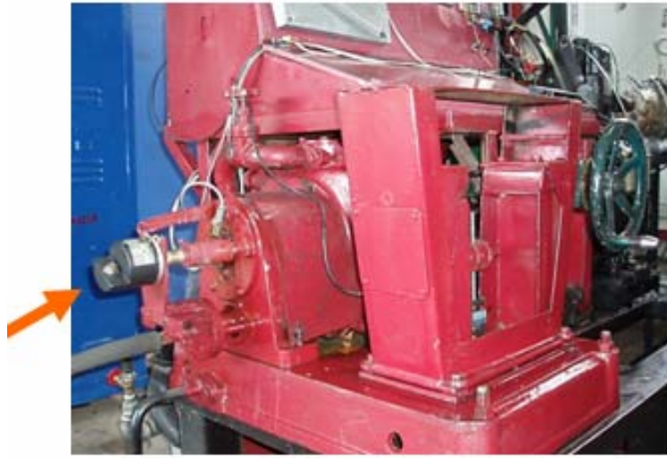
Şekil. 4.8. Devir ve açı ölçer (Encoder)
