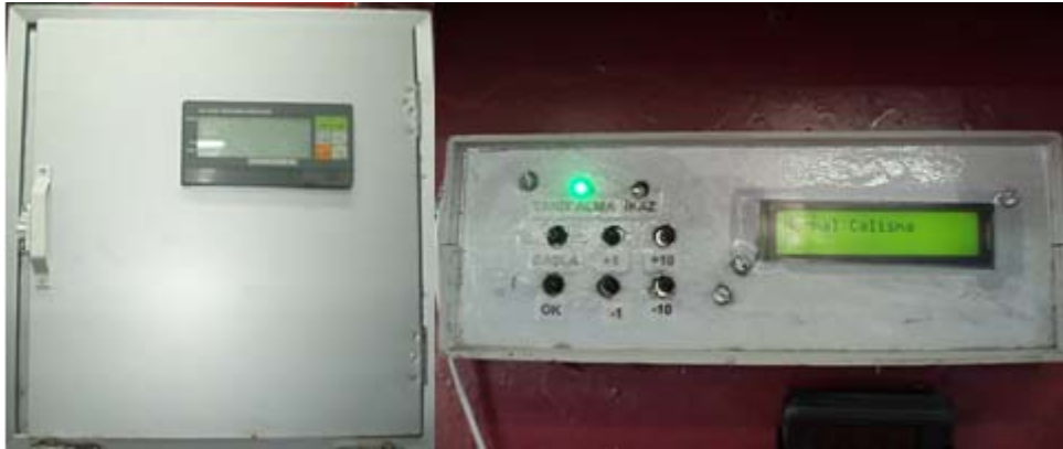
Şekil 4.20. Yakıt ölçüm cihazı ve kontrol panosu
