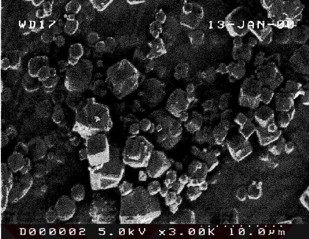
Şekil 2.4. Zeolit A kristallerinin SEM fotoğrafı ( \text{SiO}_2/\text{Al}_2\text{O}_3 oranı 1,5 kullanılarak ve 80^\circ\text{C} 'de 4 saat kristalizasyon ile hazırlanmıştır) [ 82]
