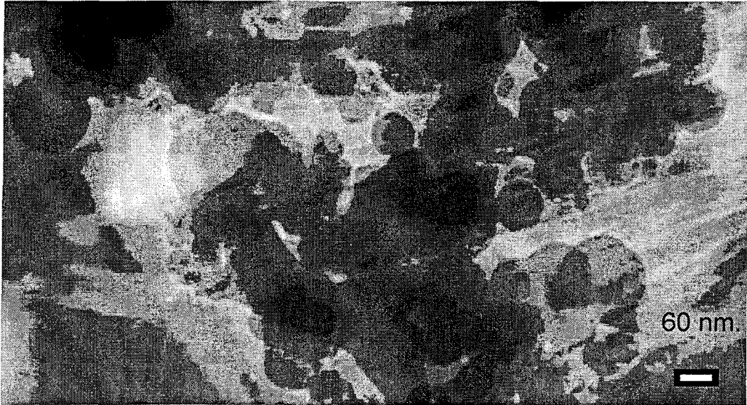
Şekil 5.11. Nano alüminyum (nano Al-INF) tozunun TEM görüntüsü (60 nm)
