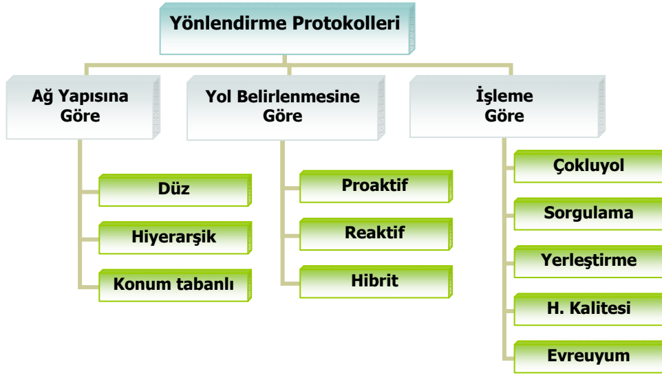
Şekil 2.10. Kablosuz algılayıcı ağları için sunulan yönlendirme protokollerinin sınıflandırılması [32]
