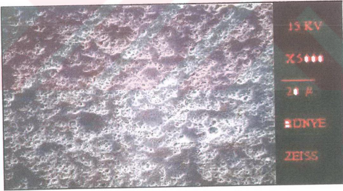
Şekil 7.19. Bünye porseleninin SEM fotoğrafı.
