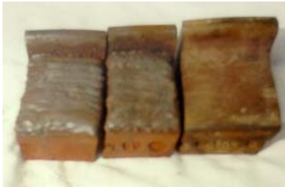
Şekil 5.5. Kaynak yapılmış numuneler (En sağdaki parçanın ilk hali)
