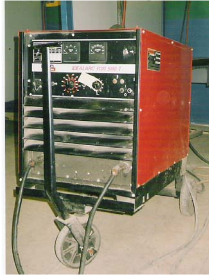
Şekil 5.7. Doğru akımla yapılan dolgu kaynağı işleminde kullanılan redresör tipi kaynak makinesi.
