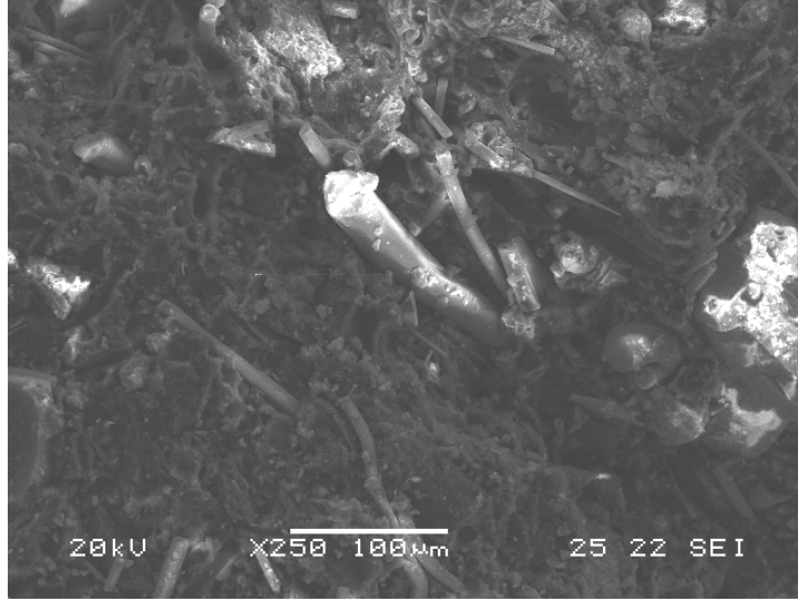
Şekil 6.69. C-C kompozit fren balatalarının mikroyapılarının SEM görüntüleri
