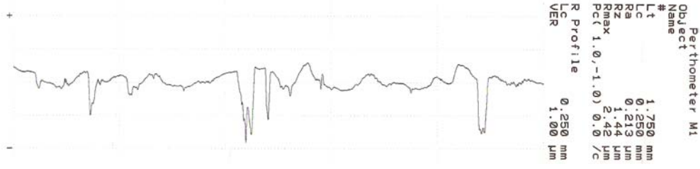
Şekil 6.81. Yaş sürtünme koşullarında Elektrot-B ile x-yönünde dolgu kaynağı uygulanan numunenin 30N’da yapılan aşınma deneyinde aşınmış yüzeyin SEM görüntüsü, çizgisel EDS-analizi ve yüzey pürüzlülüğü değerleri
