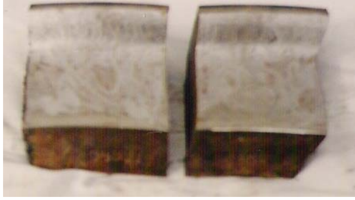
Şekil 5.2. Temizlenmiş ve kaynak işlemine hazırlanmış numuneler
