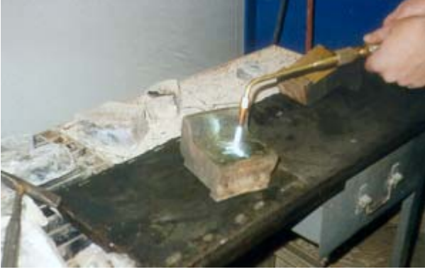
Şekil 5.3. Bandaj numunesinin ön-tavlaması
