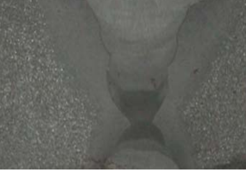
Şekil 6.61. Elektrot-A ile kaynak yapılan numunelerde kaynak bölgesi- Isının Tesiri Altındaki Bölge (ITAB) ve esas metal bölgelerinin değişimi
