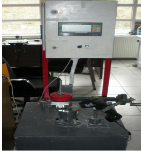
Şekil 4.40. Çalışmada kullanılan pin-disk aşınma cihazı
