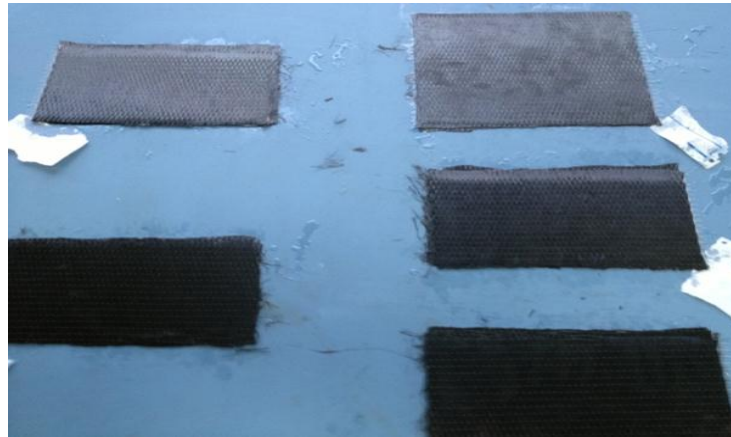
Şekil 4.2. Elle yatırılan karbon elyaf takviyeli kompozit üretimi
