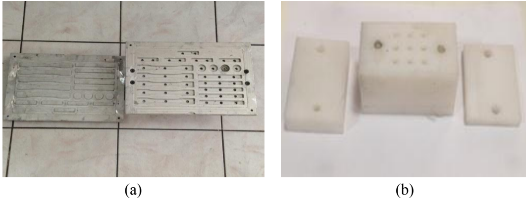
Şekil 4.1. Numune kalıpları (a) Mekanik numuneler için üretilen kalıp (b) Aşınma numuneleri için hazırlanan kalıp
