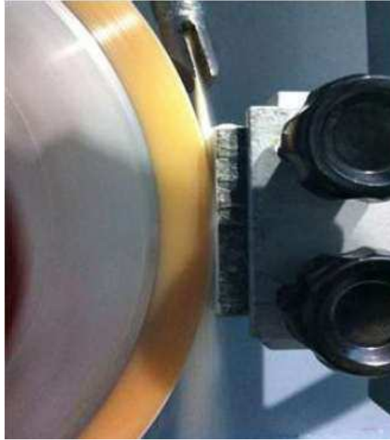
Şekil 6.7. ASTM G 65 – 04 Abrazif aşınma testi
