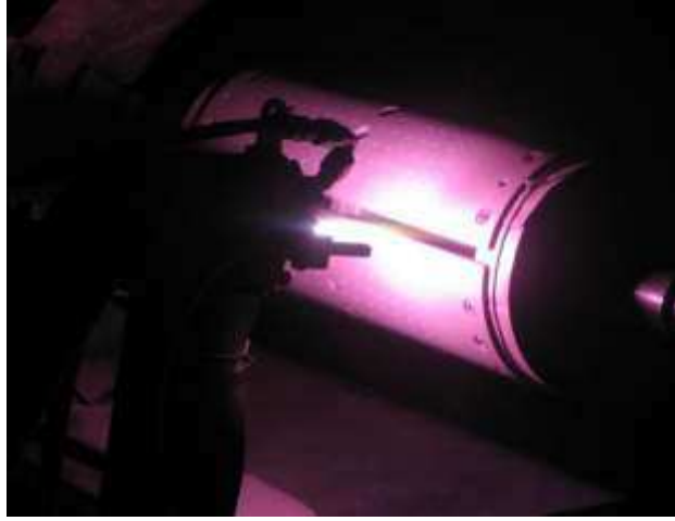
Şekil 2.6. Plazma püskürtme yöntemi
