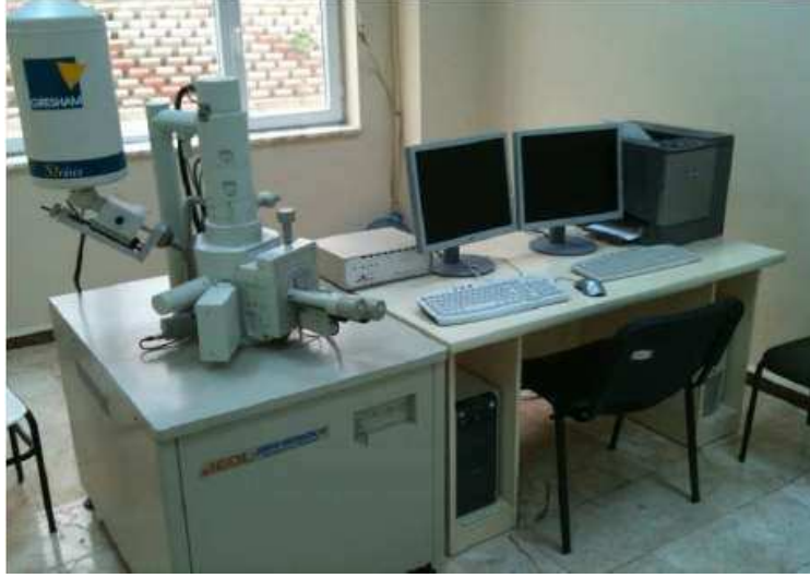
Şekil 6.2. Jeol 6060 LV marka taramalı elektron mikroskop (SEM)
