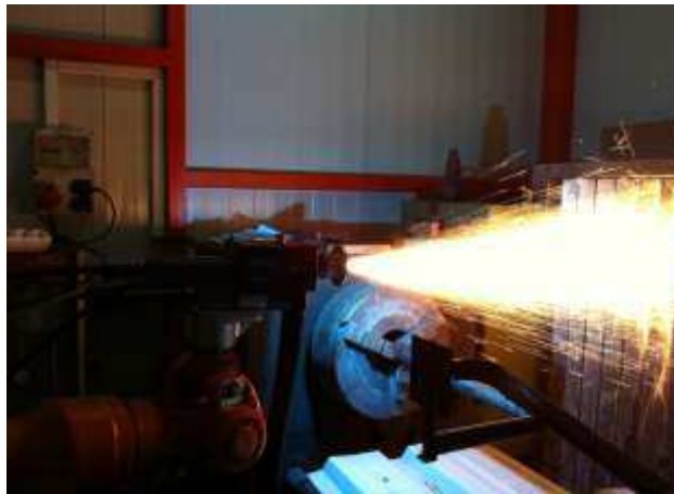
Şekil 6.1. Elektrik ark püskürtme kaplama prosesi
