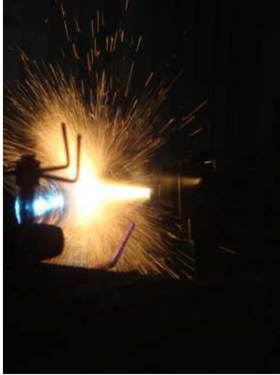
Şekil 2.5. Elektrik ark püskürtme yöntemi
