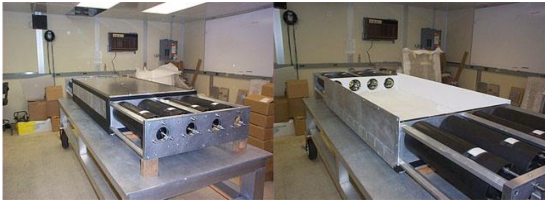
Şekil 3.26. Üzeri alüminyum profil ile kapatılarak BLAST sistemine monte edilmeye hazırlanmış son durumu (sol) ve sayaç kutularının iç kısmının Spektraflekt ile boyanmış hali (sağ)
