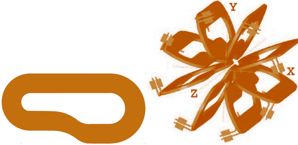
Şekil 3.34. Parçacıkların yolları boyunca 2kG'luk manyetik alan sağlayan toroidal bobinlerden birinin gösterimi (sol) ve BLAST'a azimut simetrisini sağlayacak şekilde sekiz bobinin diziliminin genel görünümü (sağ)
