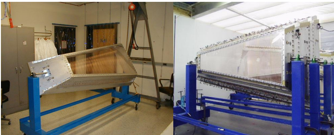
Şekil 3.22. Sürüklenme odaklarından birinin gösterimi (sol) ve üç sürüklenme odacığının birleşik hali (sağ)
