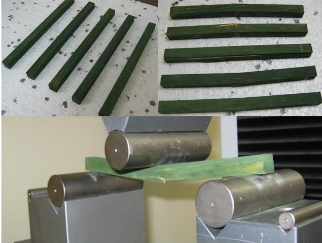
Şekil 5.49. Krom oksit nano Parçacık empenye edilmiş üç nokta eğilme deney düzeneği ve numuneleri
