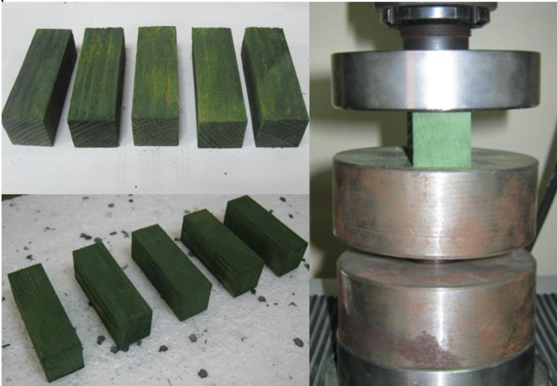
Şekil 5.46. Krom oksit nano Parçacık empenye edilmiş dik basınç deney düzeneği ve numuneleri
