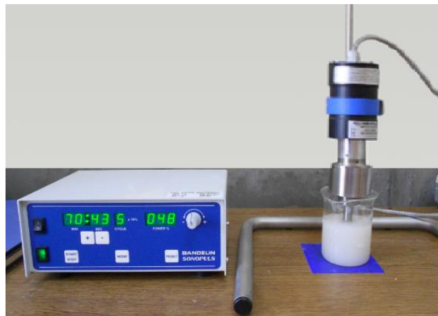
Şekil 4.5. B_2O_3 karışımının homojenizatorde disperse edilmesi
