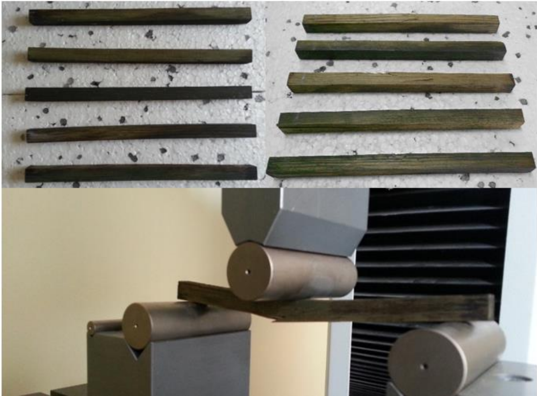
Şekil 6.13. CCB nano Parçacık empenye edilmiş üç nokta eğilme deney düzeneği ve numuneleri
