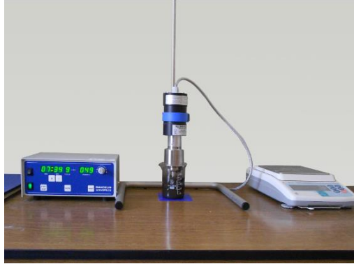
Şekil 4.1. CuO 2 karışımının homojenizatörde disperse edilmesi
