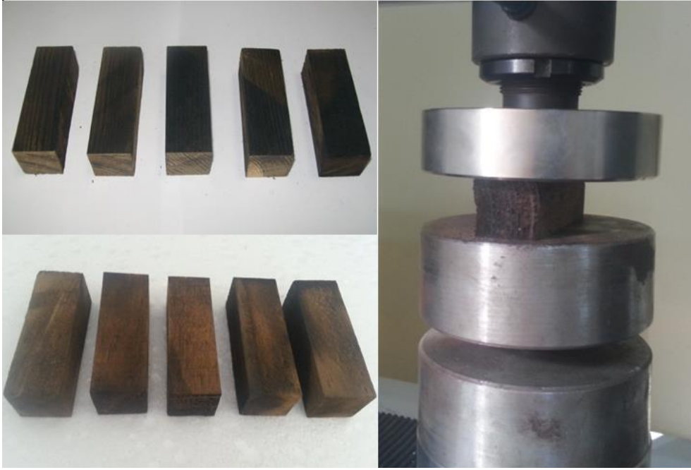
Şekil 5.10. Bakır oksit nano Parçacık empenye edilmiş numuneler ve dik basınç deneyi düzeneği
