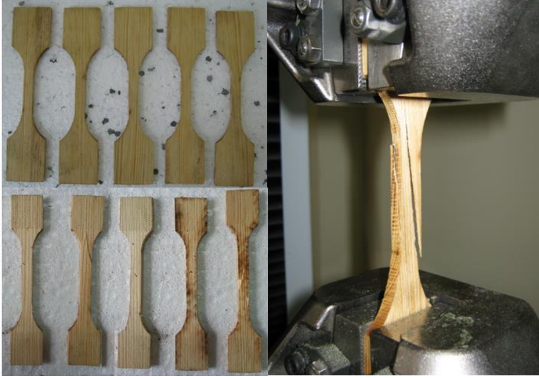
Şekil 5.19. Bor oksit nano Parçacık empenye edilmiş paralel çekme deney düzeneği ve numuneleri
