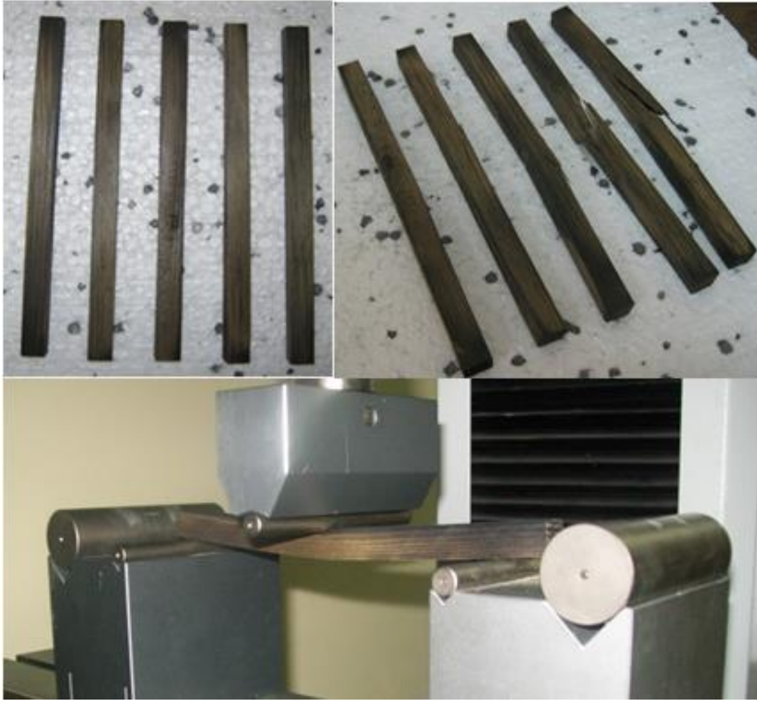
Şekil 5.13. Bakır oksit nano Parçacık empenye edilmiş numuneler ve üç nokta eğilme deneyi düzeneği
