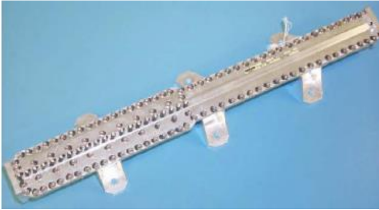
Şekil 2.2. 13.75-14.5GHz arasını geçiren, 8 kutuplu Çebişev filtresi
