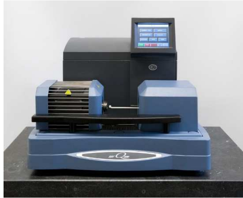
Şekil 4.11. Curie Sıcaklığını tespit etmek için kullanılan SDT Q-600 cihazı.
