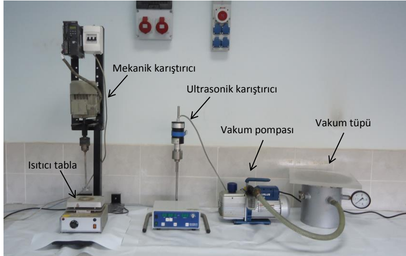
Şekil 2.2. Epoksi kompozit hazırlamada kullanılan cihazlar
