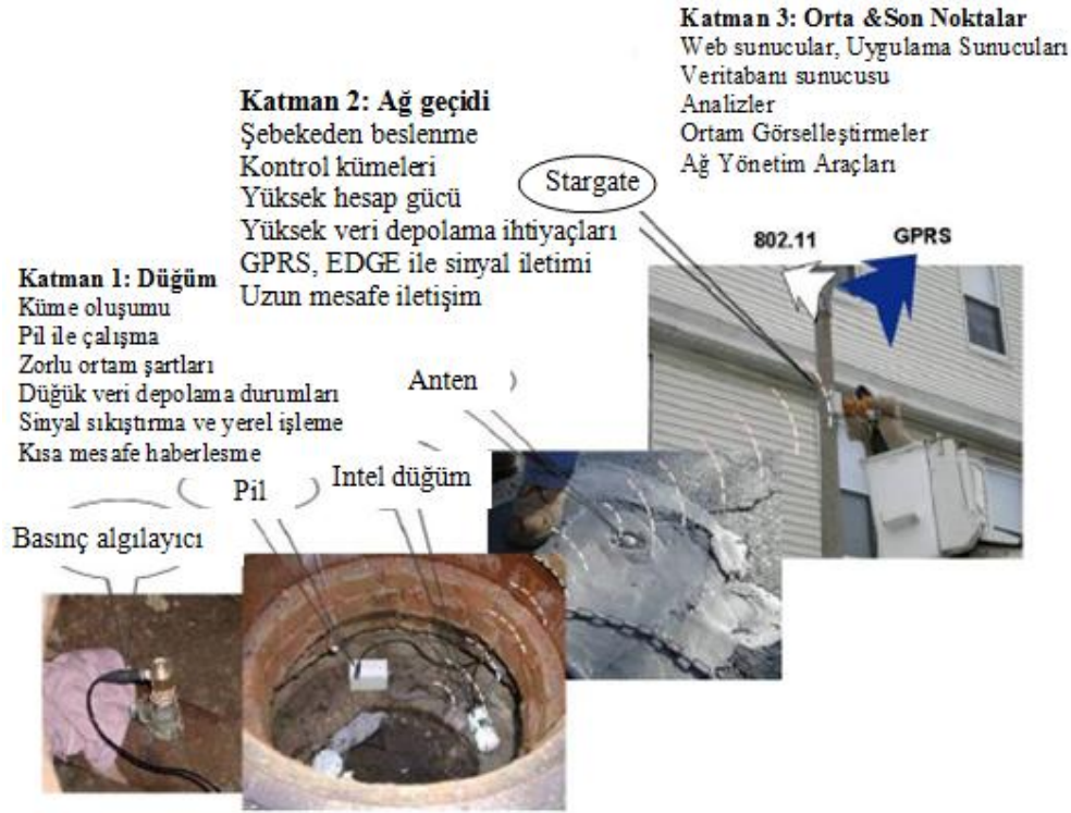
Şekil 5.3. PIPENET sistemi mimarisi
