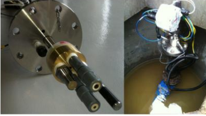
Şekil 5.4 WaterWiSe'da kullanılan çok parametrelı algılayıcı (solda) ve bir vanaya takılı hali (sağda)
