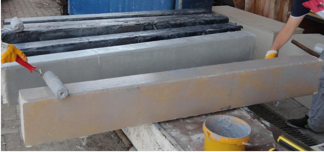
Şekil 3.11. Kiriş yüzeylerine epoksi reçinenin sürülme işlemi
