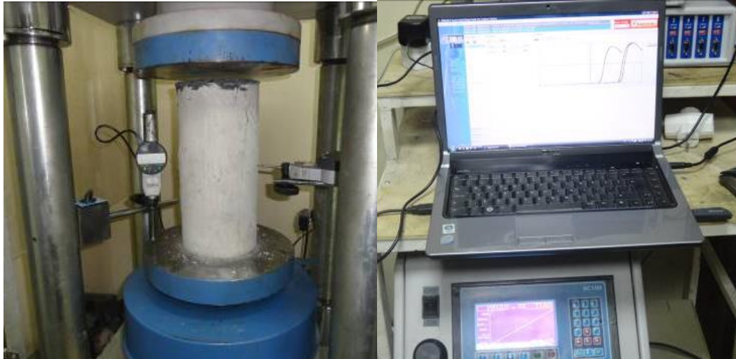
Şekil 4. 1. Şahit numunelerin beton preste kırılması ve veri aktarımı
