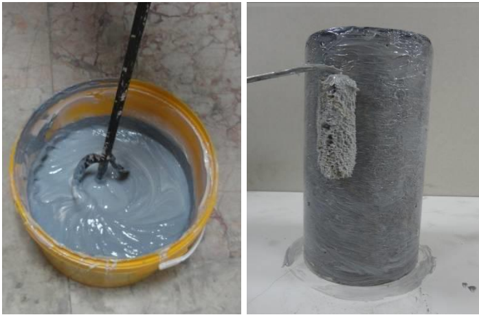
Şekil 3.2. Beton yüzeylerine epoksi reçinenin sürülmesi
