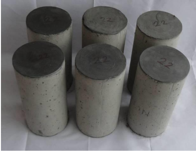
Şekil 3.1. Betonlara başlık yapılması ve yüzey hazırlığı
