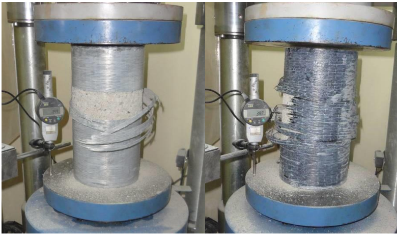
Şekil 4.6. Basınç testine tabi tutulan CFRP ve GFRP sargılı beton numuneler
