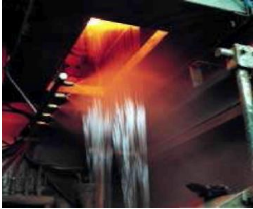
Şekil 2.5. Cam elyaf ham maddelerinin yüksek sıcaklıkta sıvı hale geçmesi
