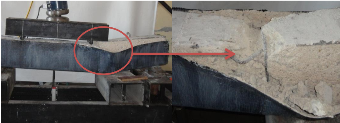
Şekil 5.14. Yükleme sonrası CFRP22 kirişi deformasyonu
