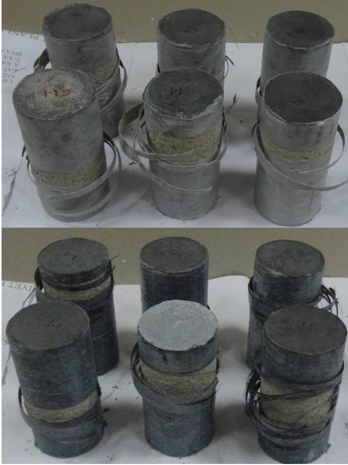
Şekil 4.7. CFRP ve GFRP sargılı beton numunelerin kırılma durumu
