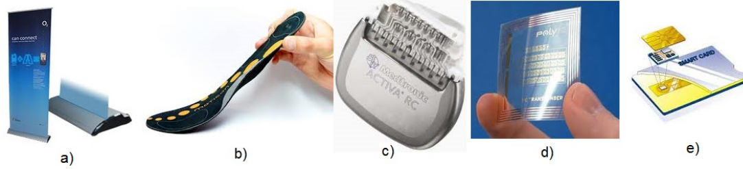
Şekil 4.8. Çok ince ve esnek pillerin kullanımı için gerekli uygulamalara örnekler a) yuvarlanabilir ekran b) giyilebilir devre (ayakkabı astarı) c) implante edilebilir medikal devreler d) RF-ID etiketi e) entegre devreli akıllı kart
