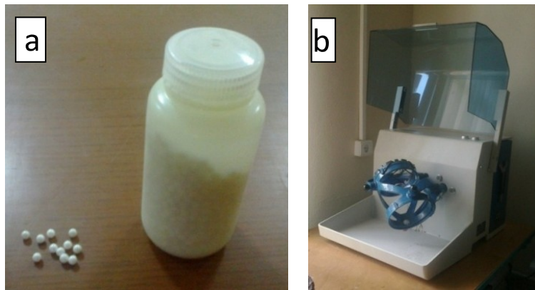
Şekil 5.1. Toz karıştırma işlemlerinde kullanılan ZrO_2 bilyeler (a), HDPE kavanoz (a) ve Turbula karıştırıcı (b)
