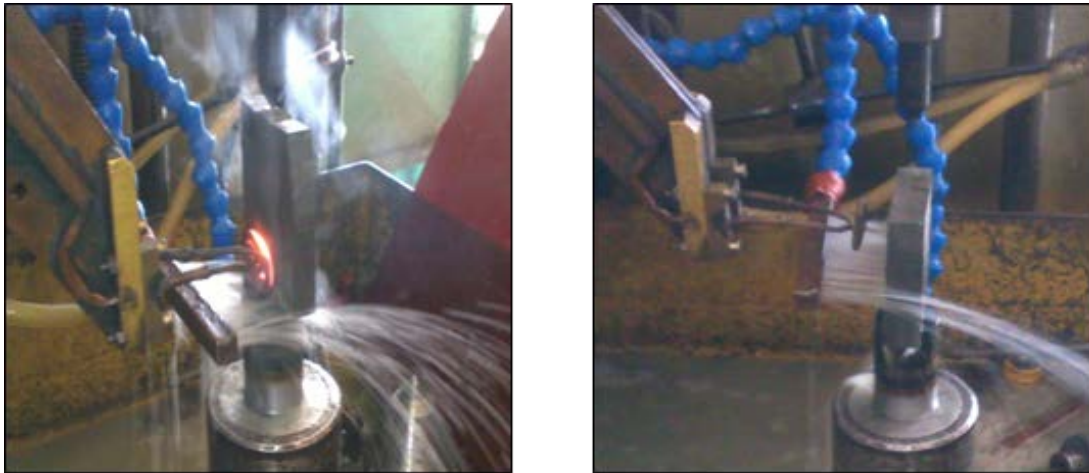
Şekil 5.6. İndüksiyonla yüzey sertleştirme işlemi uygulaması
