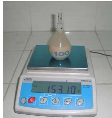
Şekil 3.18. Cam piknometreler ve numunelerin piknometre ile özgül ağırlıklarının tespit aşamaları
