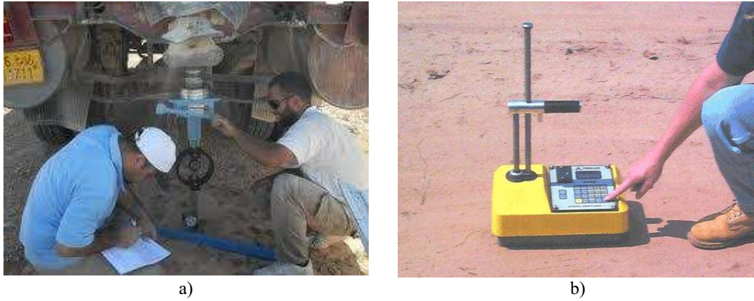
Şekil 4.2. a) Arazi CBR deneyi ve deney aleti, b) Nükleer yoğunluk ölçme cihazı
