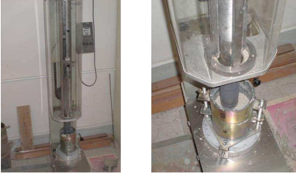
Şekil 3.16. Otomatik sıkıştırıcının genel ve yakından görüntüleri
