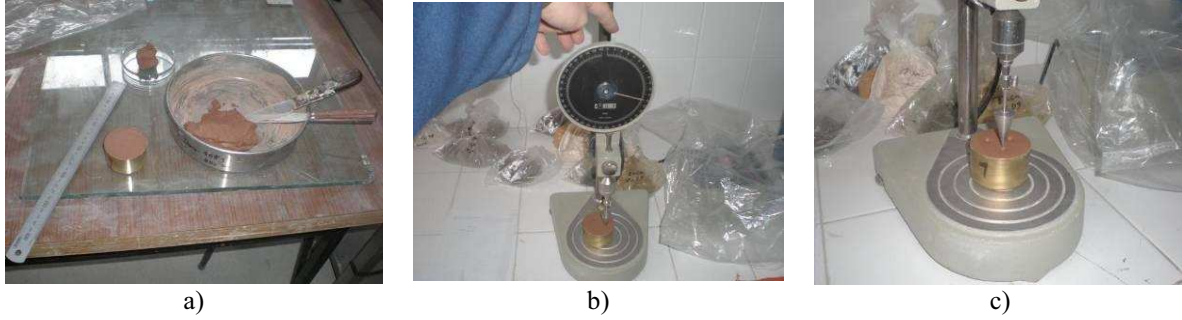
Şekil 3.20. Düşen koni aleti ile likit limitin bulunması, a) Malzemenin su ile karıştırılıp deney kabına konulması, b) Batma miktarının ölçümü, c) Üç batma sonrası numune görünümü
