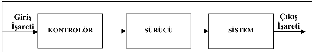
Şekil 3.1. Açık çevrim kontrol sistemine ilişkin blok gösterimi
