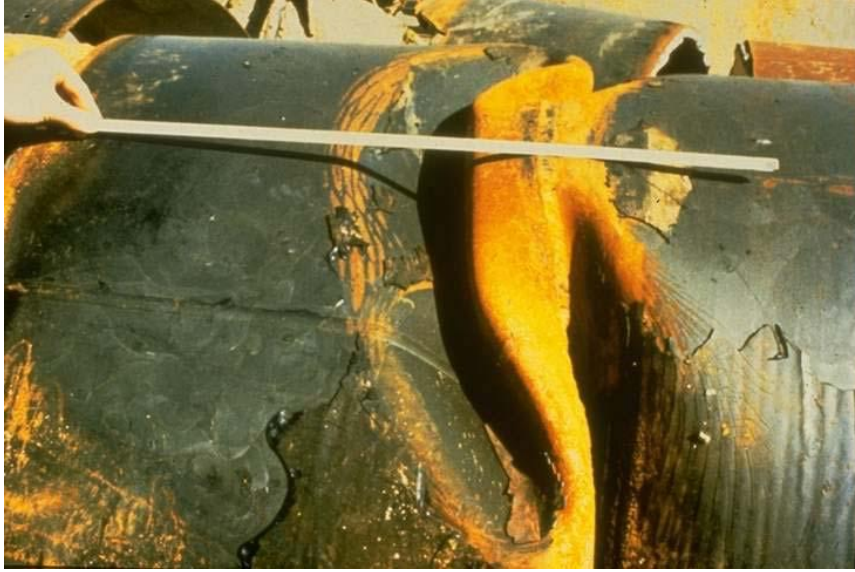
Şekil 2.7. Boruda basınç gerilmesi altında oluşan büzülme [28]
