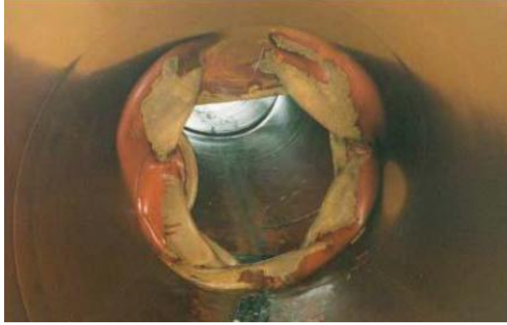
Şekil 2.6. Boruda fay kırığı hareketi sonucu oluşan büzülme [28]
