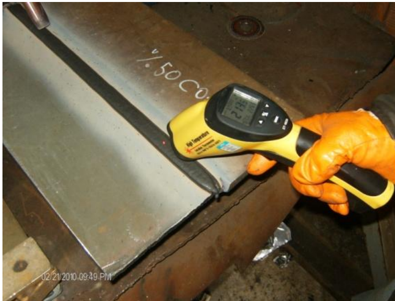
Şekil 5.2. Pasolararası sıcaklık ölçümü
