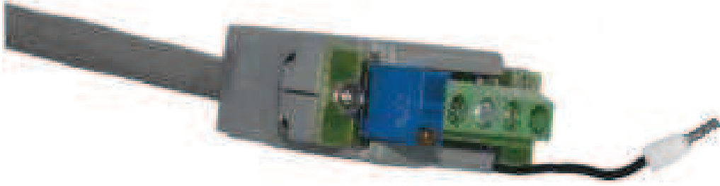
Şekil 3.11. TESTBOX-QCABLE devre tamamlama kablosu (Teknik Destek Grubu, 2011)
