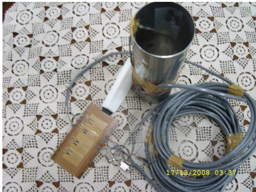
Şekil 3.26. Elektronik devreyle Wheatstone Köprüsü tamamlama
