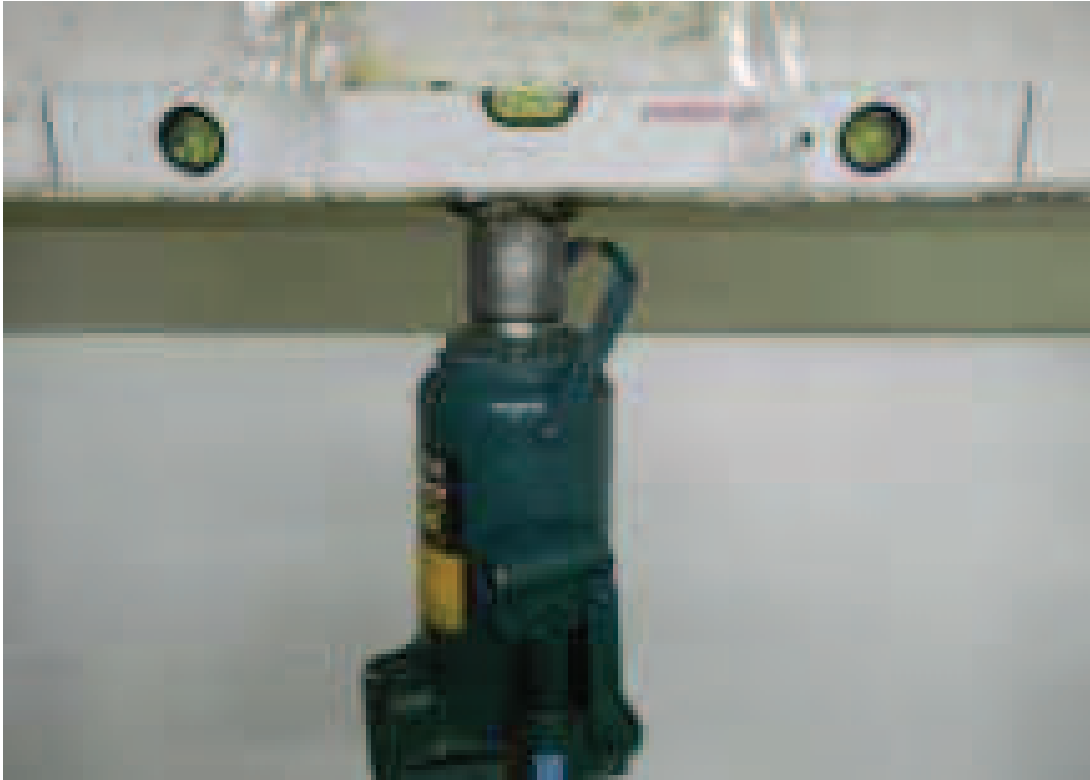
Şekil 4.13. Çerçeve üst kirişinin teraziye alınması
