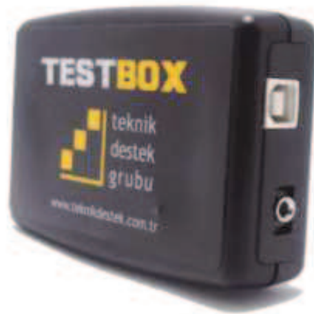
Şekil 3.10. TESTBOX-BRIDGE aygıt geçidi
