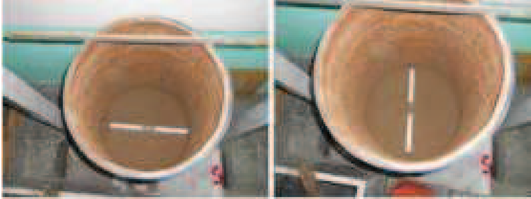
Şekil 4.11. Tamamlanan tabaka için tesviye kontrolü
