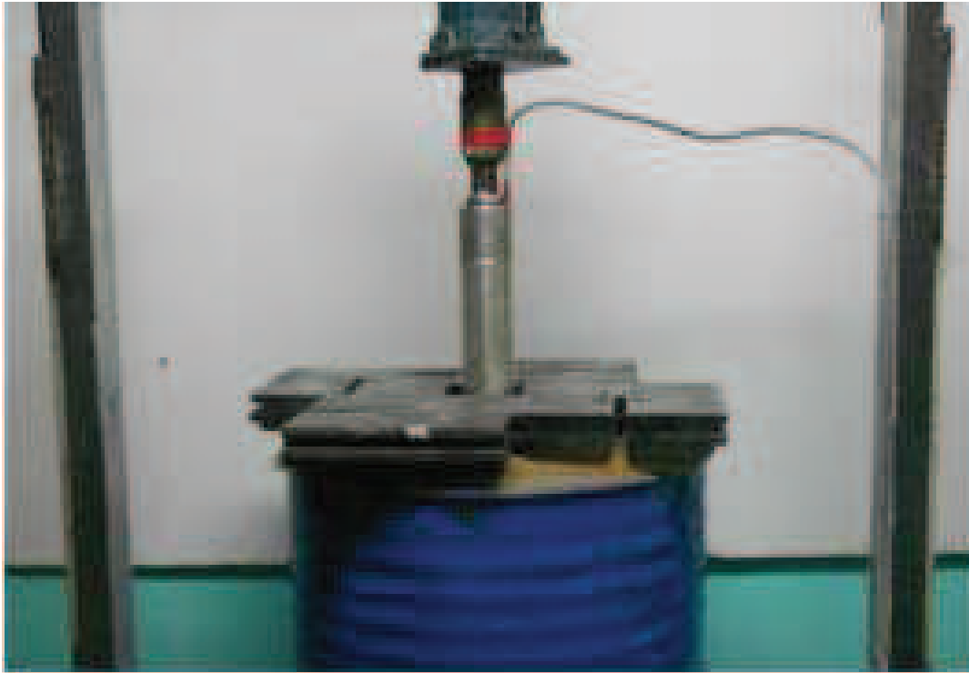
Şekil 4.16. Penetrometre ilk bölümünün zemine itilmesi
