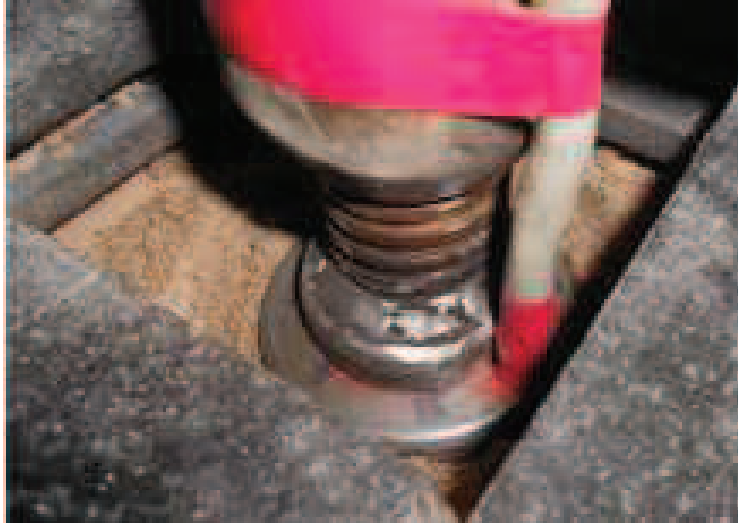
Şekil 4.17. Penetrometrenin tamamının zemine itilmiş görüntüsü
