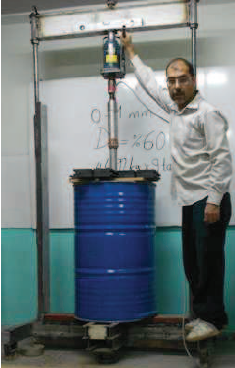
Şekil 4.15. Penetrometrenin zemine itilmesi
