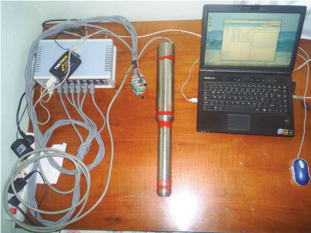
Şekil 3.20. Penetrometre ve veri toplama sistemi
