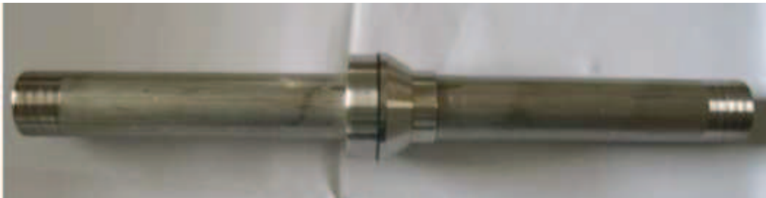
Şekil 3.15. Penetrometrenin taşıyıcı iç bölümü
