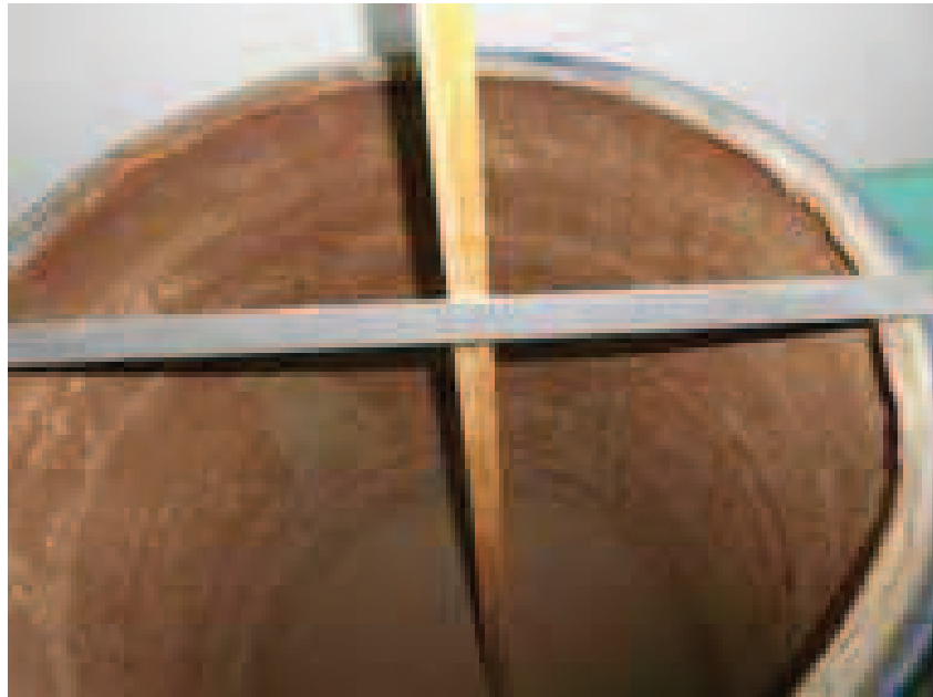
Şekil 4.10. Bir tabaka için gevşek halde ön tesviye kontrolü
