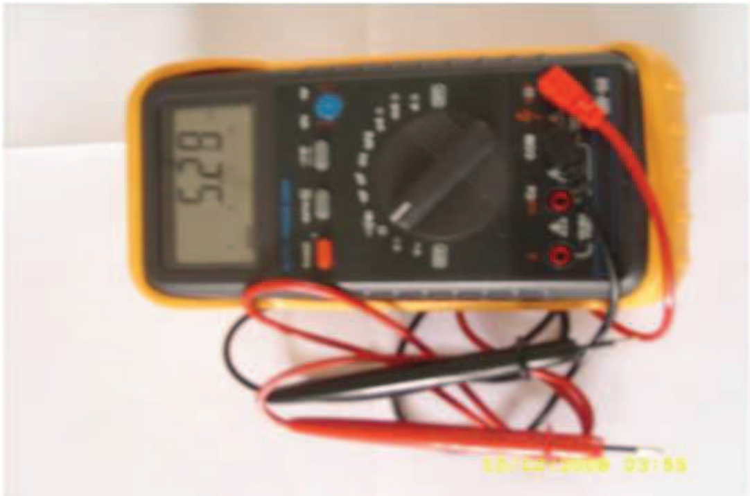
Şekil 3.25. Strain gauge bağlantılarının kontrolünde kullanılan avometre
