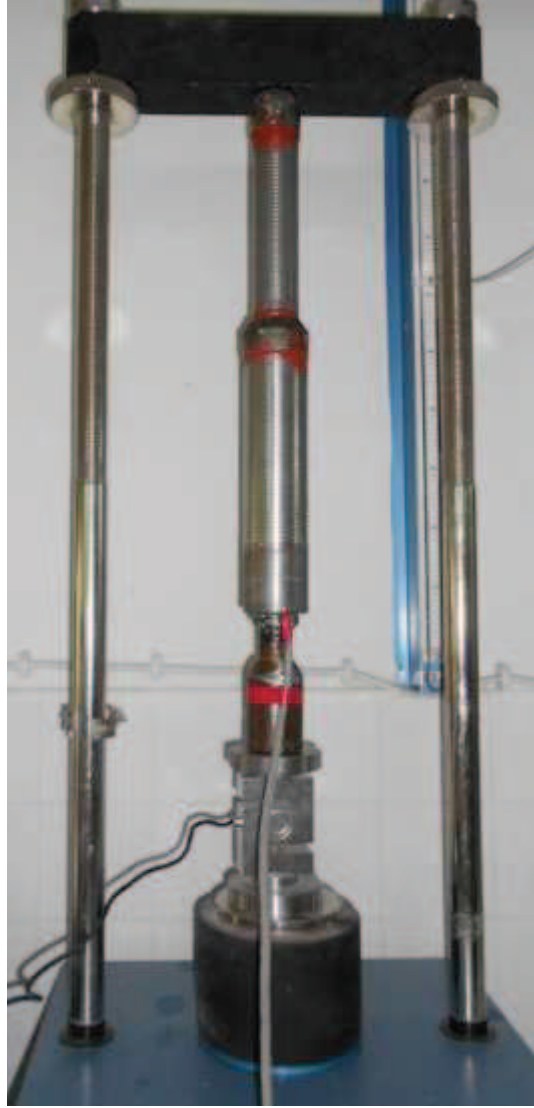
Şekil 3.28. İç taşıyıcı boruların (uç ve genişletme direnci) kalibrasyonu
