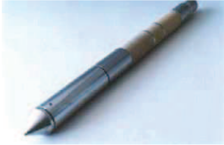
Şekil 2.36. Nem sondası (Lankelma, 2008)
