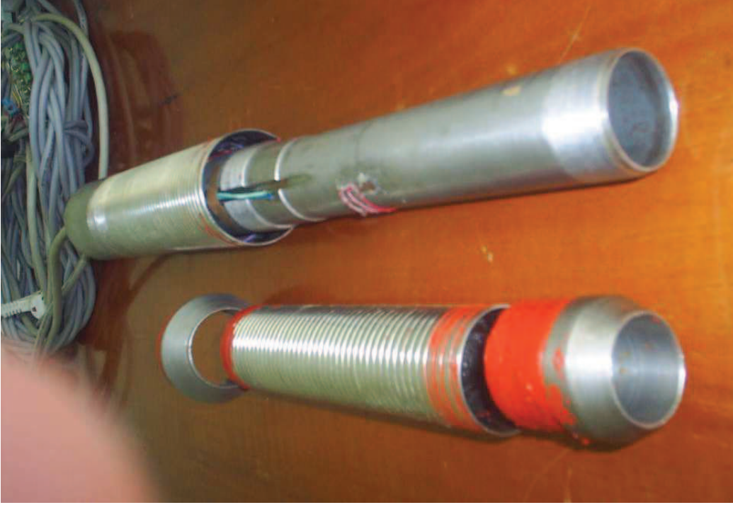
Şekil 3.19. Penetrometrenin son tasarım şekli
