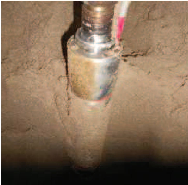
Şekil 4.18. Penetrometrenin, çevresi boşaltılarak çıkarılması
