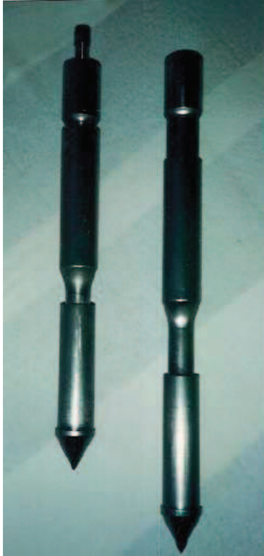
Şekil 2.21. Begemann mekanik sürtünme konileri (penetrometreleri)
