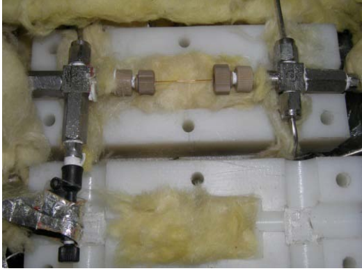
Şekil 4.2.a Mikroboru test ünitesi
