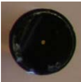
Şekil 4.3.a Ergimiş silis boru kesiti: 20 µm
