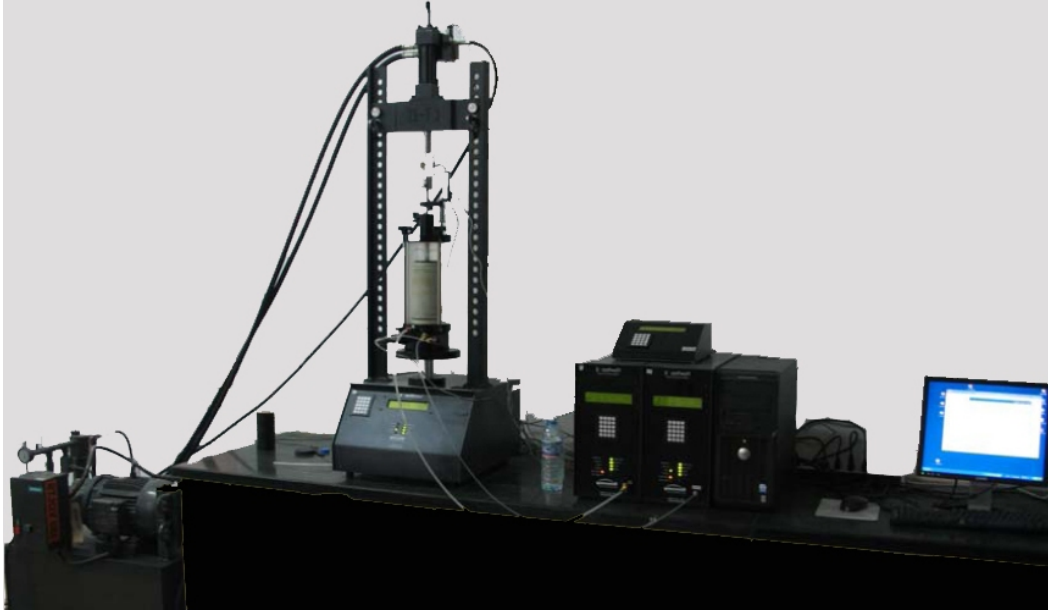
Foto 5.1. Geocomp üretimi tekrarlı üç eksenli deney sistemi
