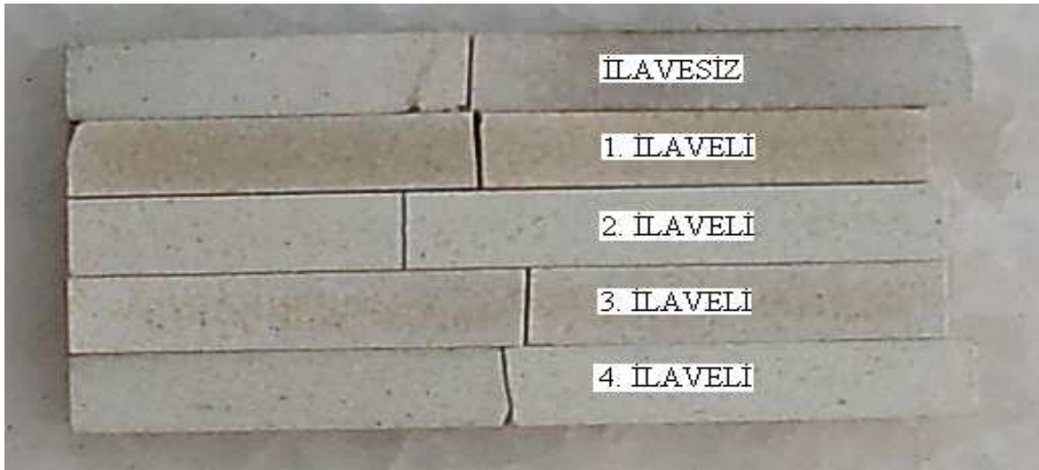
Şekil 6.5. Sinterlenmiş numunelerde boyut ve renk değişimleri
