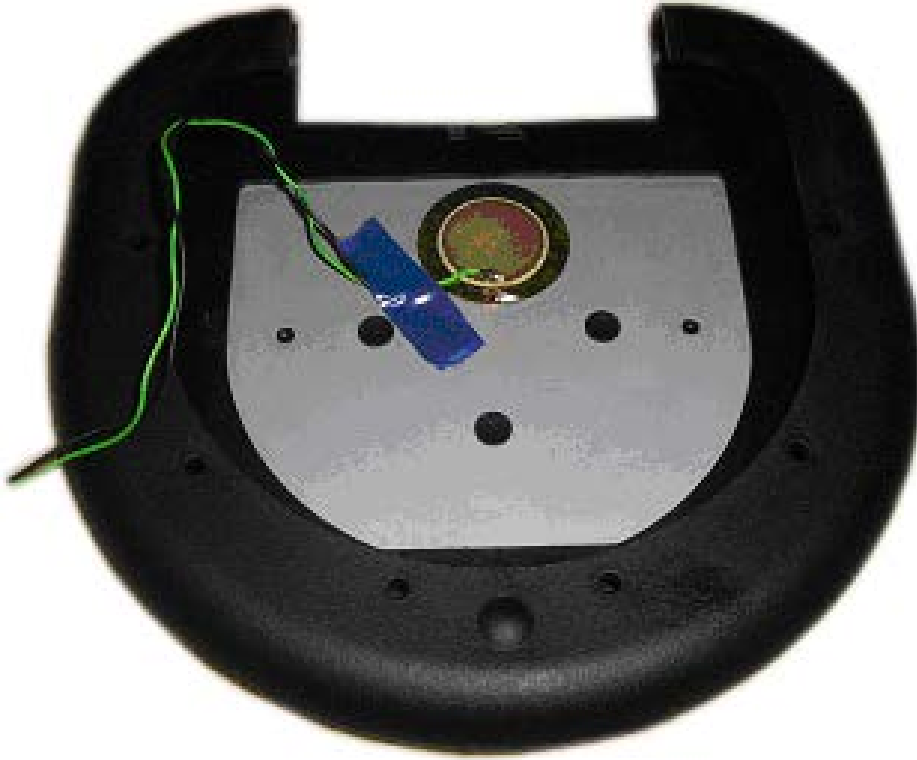
Şekil 3.3. Piezofilm Sensör Uygulanmış Pad
