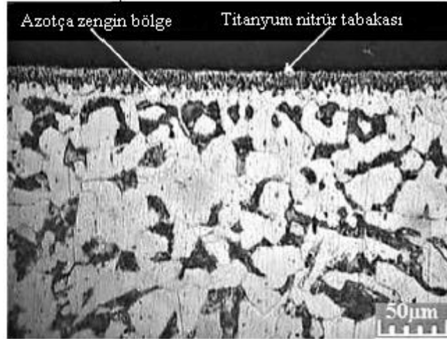
Şekil 4.2. Termo reaktif difüzyon yöntemiyle elde edilmiş titanyum nitrür tabakasının mikroyapı görüntüsü [47].
