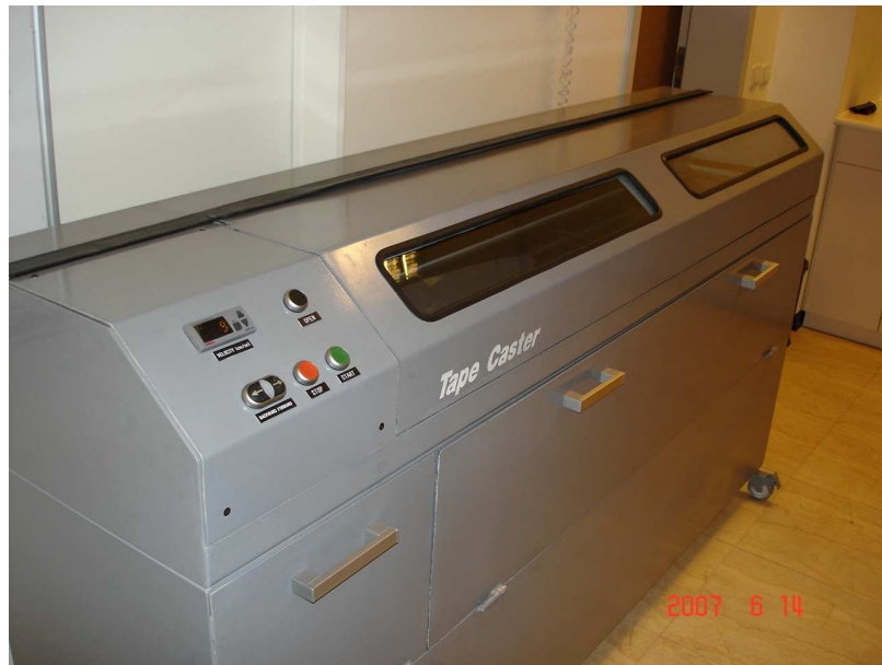
Şekil 3.6. Numunelerin basınçsız olarak şekillendirilmesinde kullanılan şerit döküm cihazı
