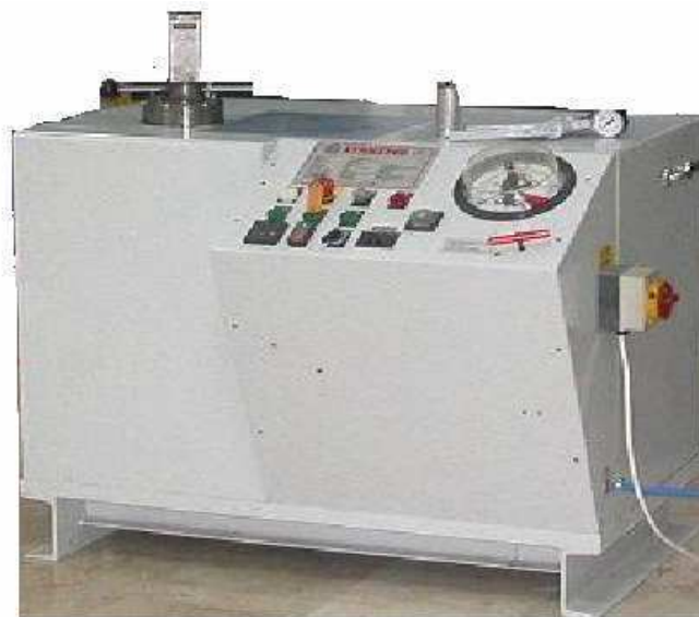
Şekil 3.5. Numunelerin şekillendirilmesi için kullanılan CIP cihazı
