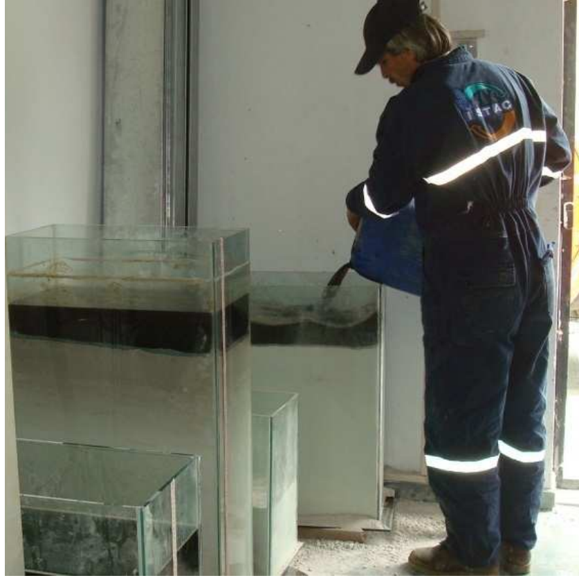
Şekil 4.9. Katı Atık Sızıntı Suyunun Deney Düzeneklerindeki Minyatür Sahalara Dikkatlice Boşaltılması
