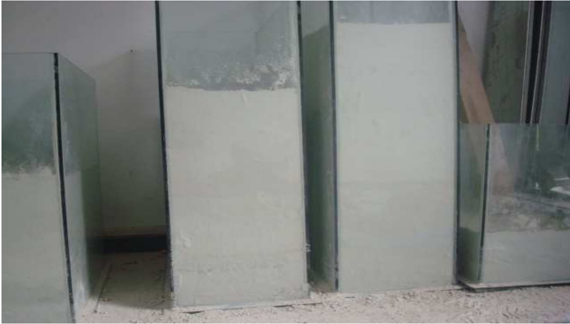
Şekil 4.7. Minyatür Saha Düzeneklerindeki Sıkıştırılmış Kil Malzemesi ( Soldan Sağa; 40 cm, 60 cm, 80 cm, 20 cm)
