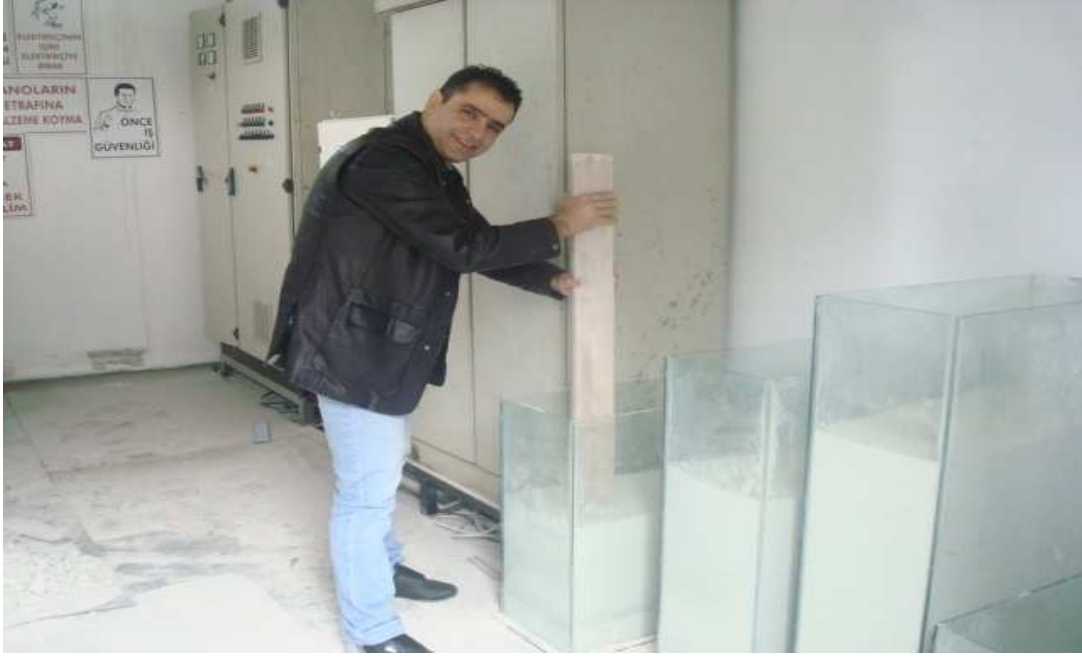
Şekil 4.6. Kil Malzemesinin Minyatür Saha Düzeneğine Yerleştirilip Sıkıştırılması
