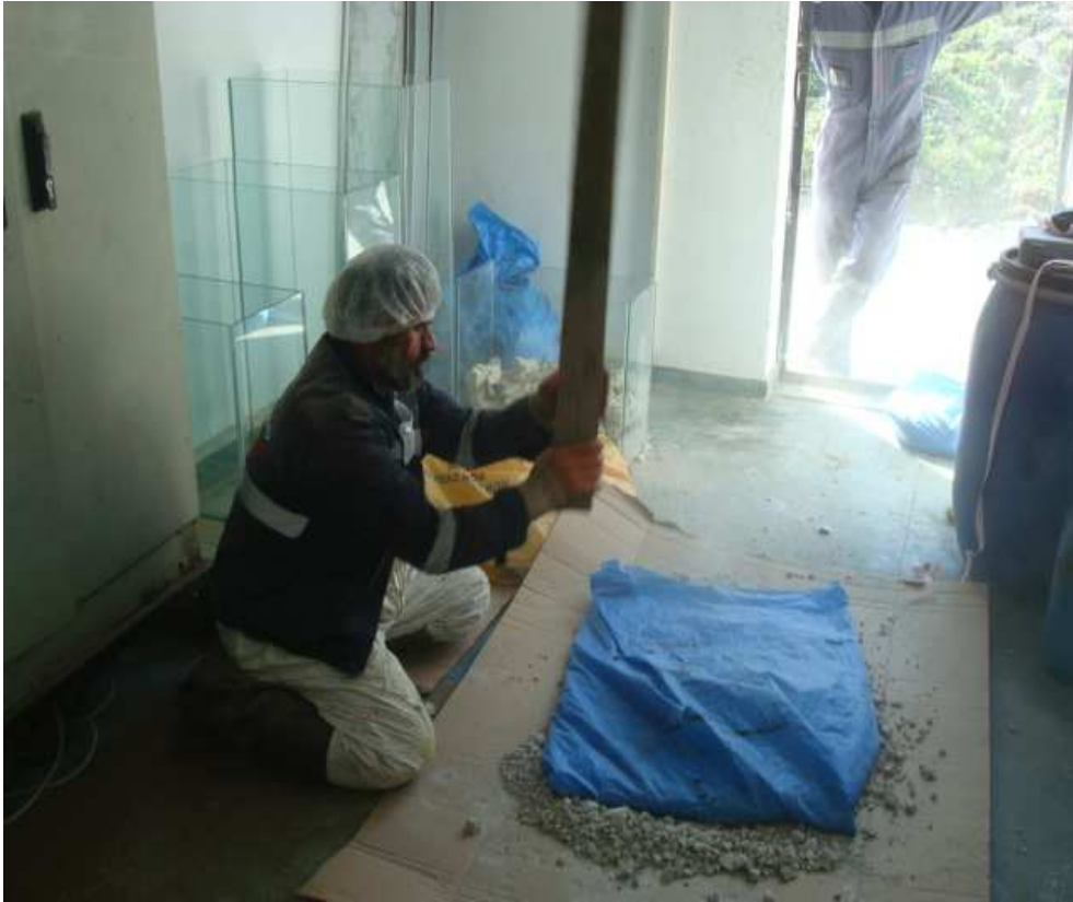
Şekil 4.5. Topaklaşmış Kil Malzemesinin Dövülüp Ufalanması
