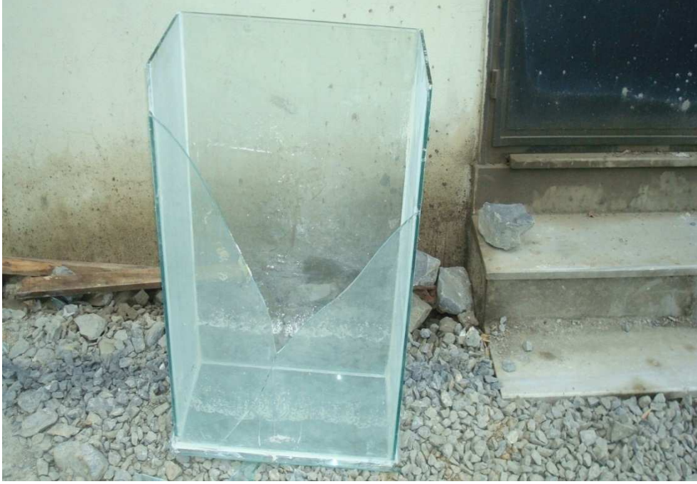
Şekil 4.3. 6mm Camdan Yapılan Minyatür Saha Düzeneginin Kırılması
