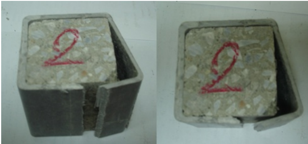
Şekil 5.6. Basınç deneyi sonrası deforme olmuş Hibrit küp numuneleri
