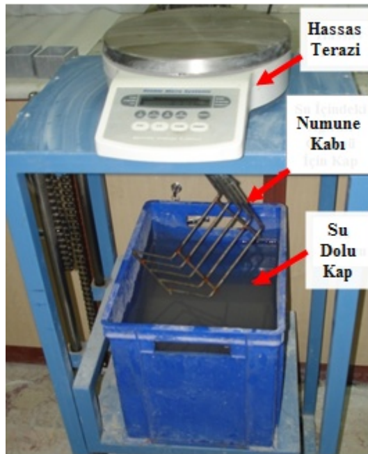
Şekil 4.2. Özgül Ağırlık deneyinde kullanılan Arşimet terazisi
