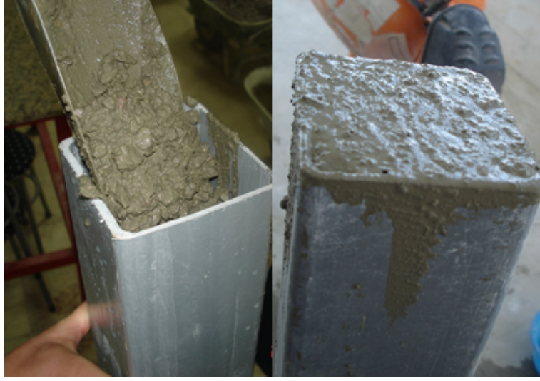
Şekil 1.5. Betonun GFRP kutu profil içerisine yerleştirilmesi
