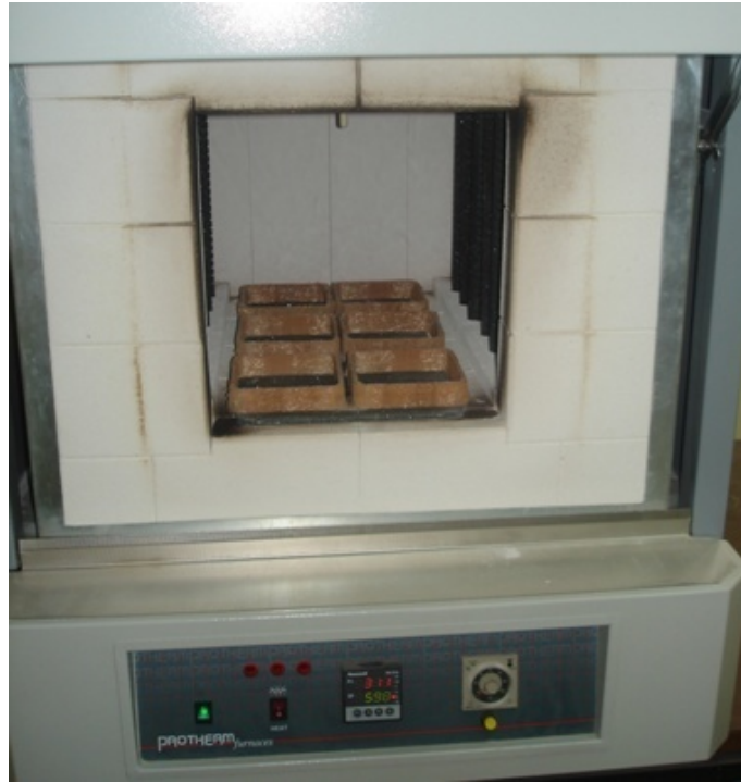
Şekil 4.12. Reçine yakma işleminde kullanılan fırın ve numuneler
