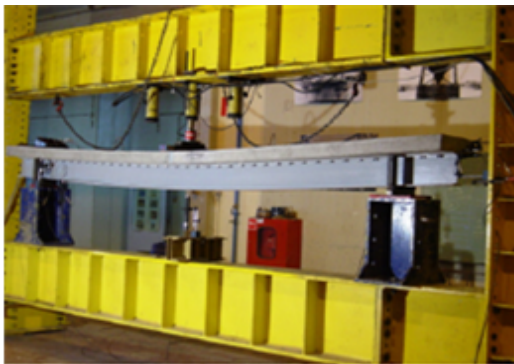
Şekil 2.33. Beton ile I kesitli GFRP profilden oluşturulmuş Hibrit kiriş testi [85];
