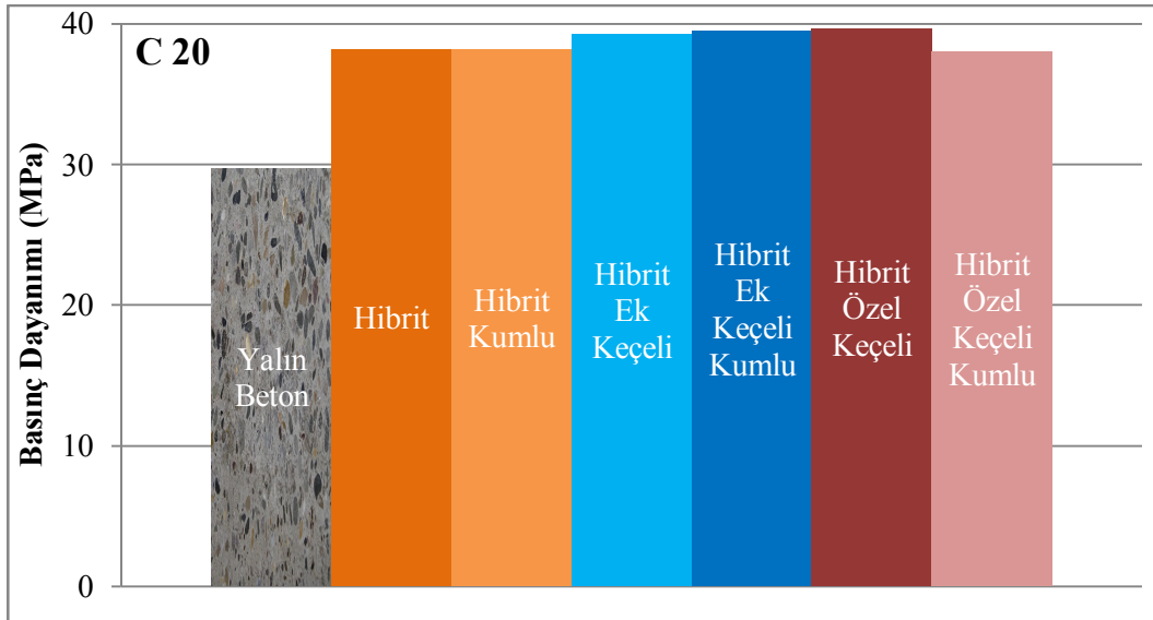
Şekil 5.8. GFRP profil özelliklerinin basınç dayanımına etkileri (C20)
