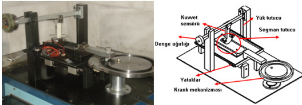
Şekil 4.5. Aşınma cihazı ve şematik görünümü
