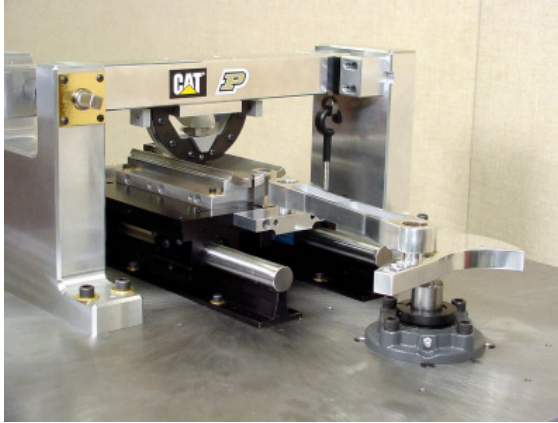
Şekil 2.12. Segman ve gömlek sürtünmesi ölçüm cihazı (Sadeghi,2004-Bolander, 2004)
