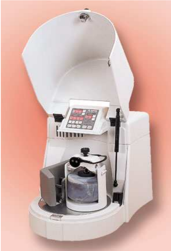
Şekil 4.2 Deneysel çalışmalarda kullanılan gezegensel değirmen
