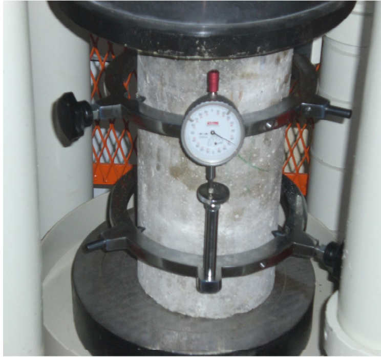
Şekil 3.11. Statik elastisite modülü deneyi ve ölçüm çerçevesi
