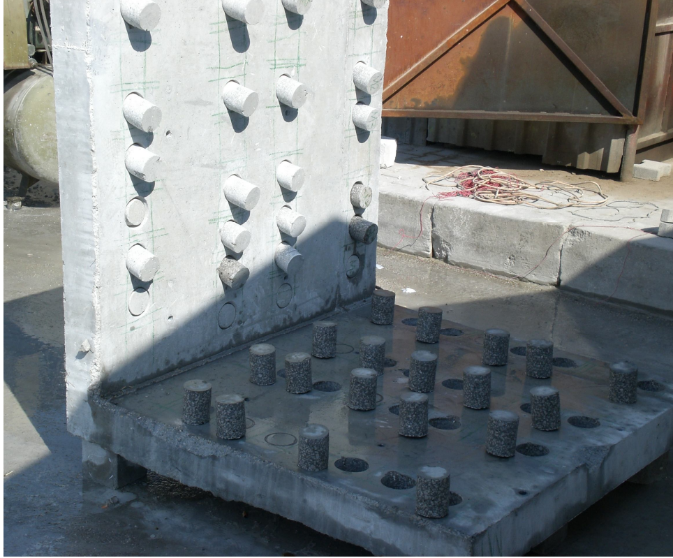
Şekil 3.18. Karot numune alınmış perde elemanları
