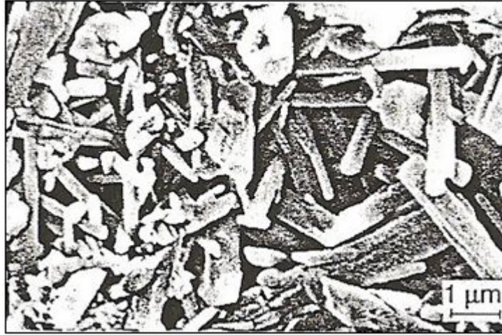
Şekil 3.27. Basınçsız sinterlenmiş (SSN) Si 3 N 4 'ün tipik mikro yapısı Terwilliger (1975)
