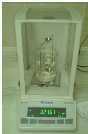
Şekil 5.15. Sinterlenmiş numunelerin yoğunluklarının ölçüldüğü yoğunluk kitleleriyle birlikte 1/10000 gr hassasiyetli terazi
