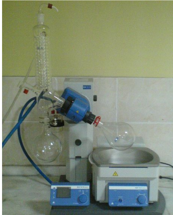
Şekil 5.8. Toz hazırlamada kullanılan IKA marka RV 10 model rotary evaporatör
