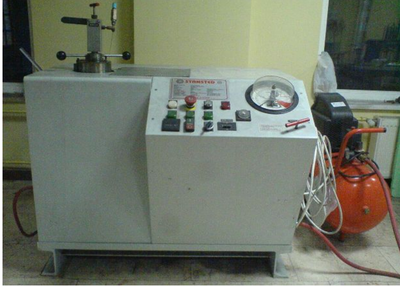
Şekil 5.10. Seramik peletlerin yoğunluklarının artırılmasında kullanılan Stansted Fluid Power firmasına ait FPG2330A-40 model soğuk izostatik pres (maksimum 270MPa'lık)
