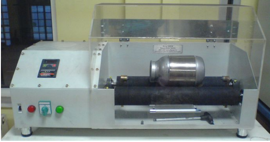
Şekil 5.7. Toz hazırlamada kullanılan bilyeli değirmen cihazı (Sakarya Üniversitesi Metal Eğitimi bölümünde yapılmıştır) ve Si_3N_4 bilyeler
