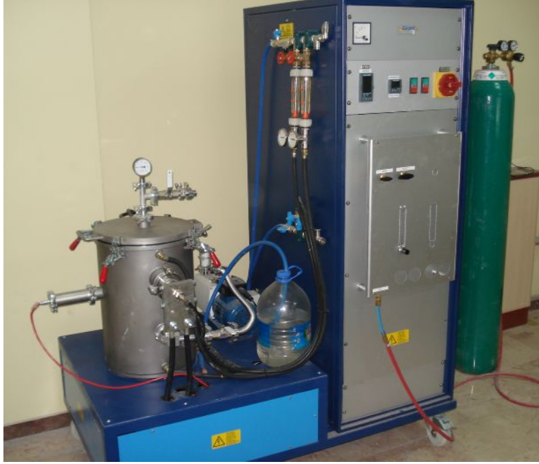
Şekil 5.12. Sinterleme işleminin yapıldığı GERO marka LHTG100-200/20 model grafit rezistanslı ve atmosfer kontrollü basınçsız sinterleme fırını (maksimum 2200°C'lik)
