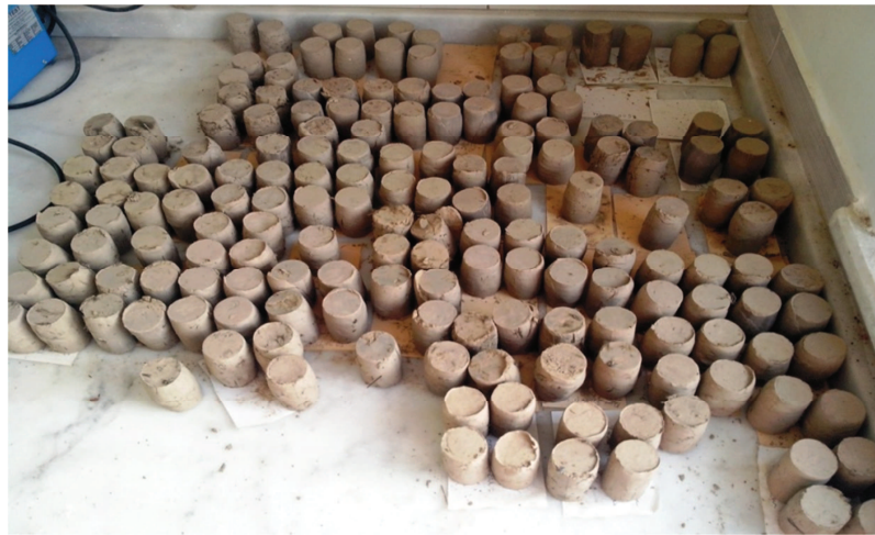
Şekil 5.6. UU deneyleri sonrası bütün zemin örnekleri
