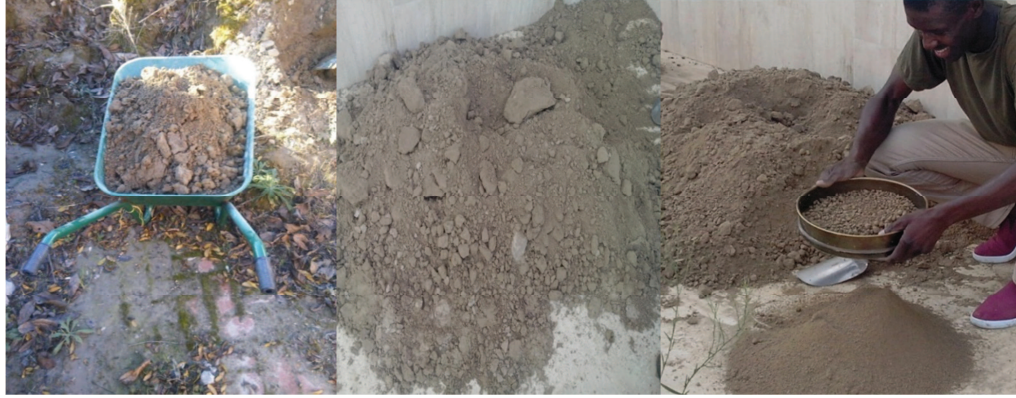
Şekil 4.2. Numunenin depo alanından laboratuvara taşınması ve 2,36 mm açıklıklı elekten elenmesi
