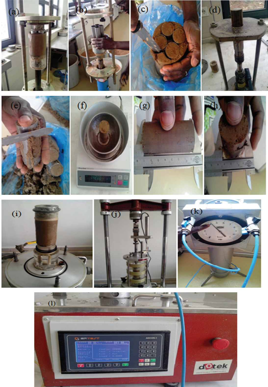
Şeki 4.18. Üç eksenli hücre kesme deneyi aşamaları, (a, b) doymun ve doymun olmayan numunelerin büyük kriko ile küçük tüplere alınması, (c, d, e) numunelerin küçük tüplerden çıkarılması, (f) numunelerin tartılması, (g, h) numunelerin boyu ve çapının ölçülmesi, (i) lastik membran yerleştirilmesi, (j) deformasyon ölçüm mekanizmasının oturtulması, (k) çevre basıncının ayarlanması, (l) okuma
