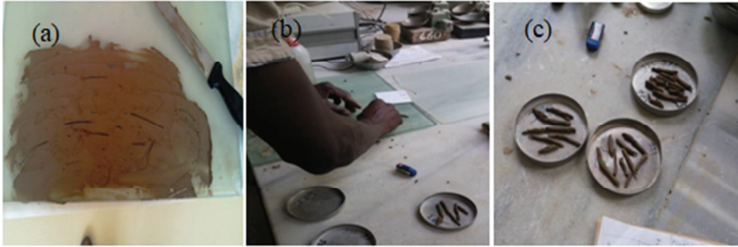
Şekil 4.6. Plastik limit deneyi, (a) numune, (b) yuvarlama işlemi, (c) 3 mm çapında çatlama numune
