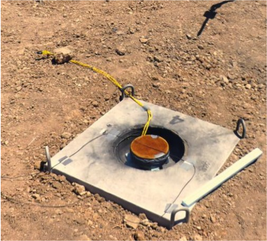
Şekil 4.2. Kara mayınının çanak içerisine konumlandırılması
