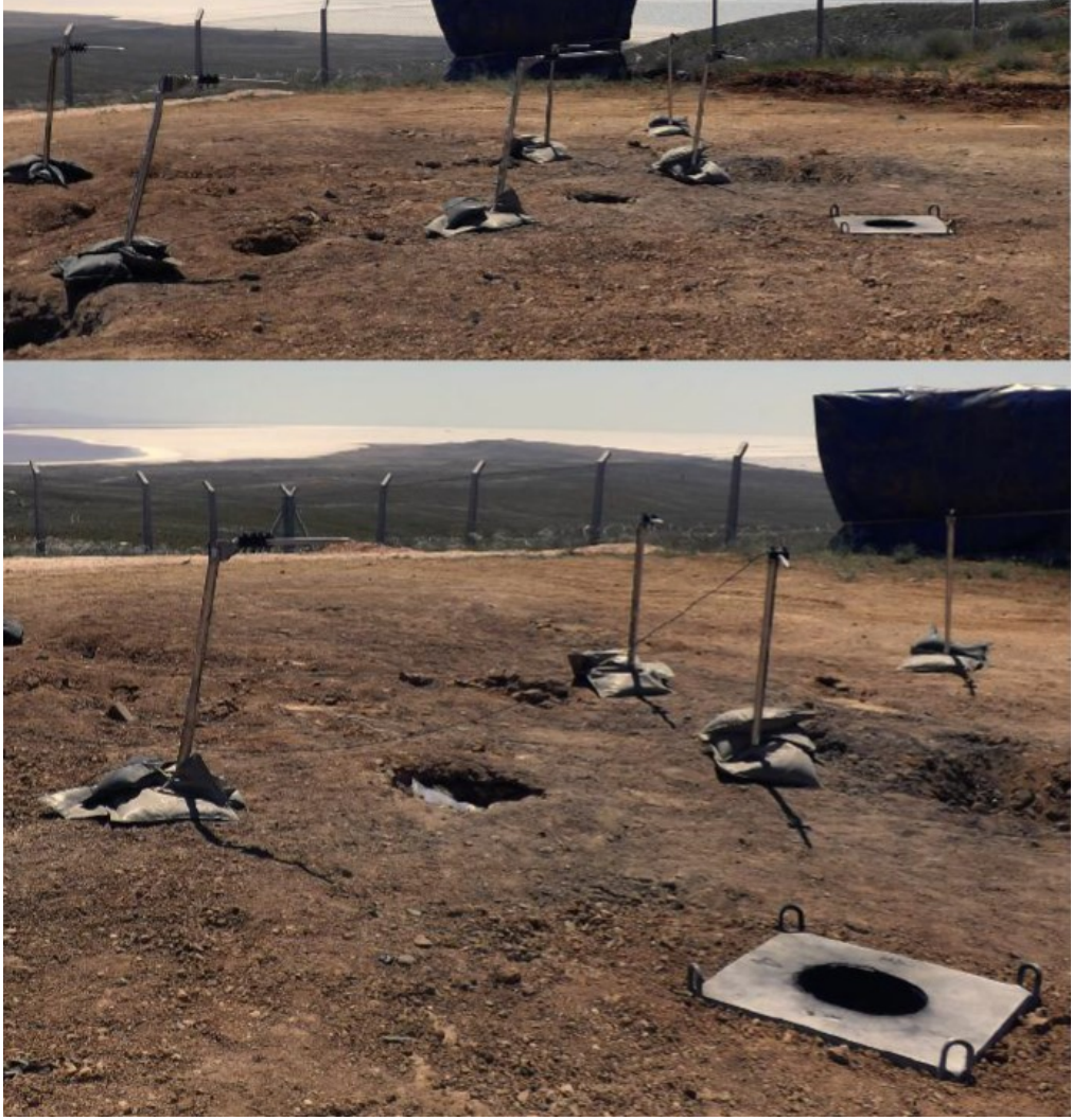
Şekil 4.5. Patlama basıncı sensör yerleşimi
