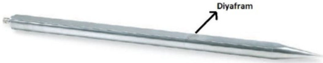
Şekil 4.3. Kalem tipi patlama basıncı ölçüm sensörü
