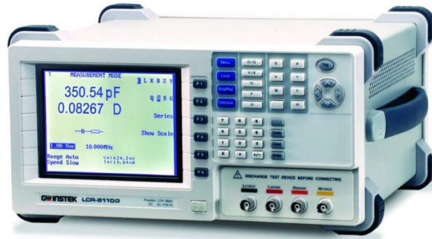
Şekil 3.9. Dielektrik ve iletkenlik ölçümleri için kullanılan LCR-metre.
