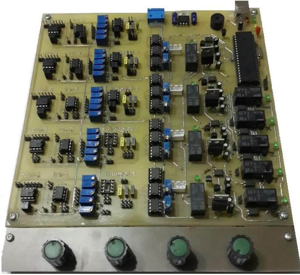
Şekil 4.13. Bilgisayar ve mikro denetleyici kontrollü KDDS gerçek devresi
