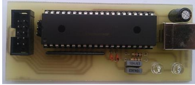
Şekil 6.8. Mikro denetleyici kontrollü veri toplama kartı
