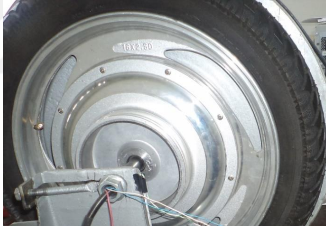
Şekil 2.5. Tekerlek içi elektrik motorunun jant, lastik, kapak ve rulman yapısı
