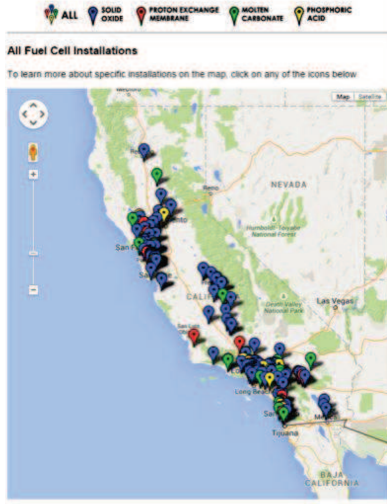
Şekil 1.8. Kaliforniya'da kurulmuş güç santralleri ve kullanılan yakıt hücresi türü
