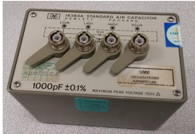
Şekil 3.16. TÜBİTAK UME'de bulunan HP16384A model 1000 pF dört uçlu ve ekranlı kapasitans standardı
