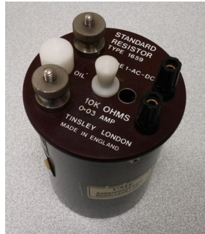
Şekil 3.12. TÜBİTAK UME'de bulunan TINSLEY 1659 model dört uçlu direnç standardı
