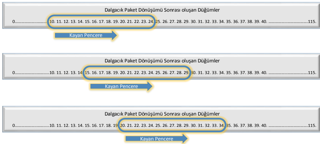
Şekil 5.5. Düşümler üzerinde 15 adet düğüm içeren ve 5 düğüm kaymalı pencerenin hareketi
