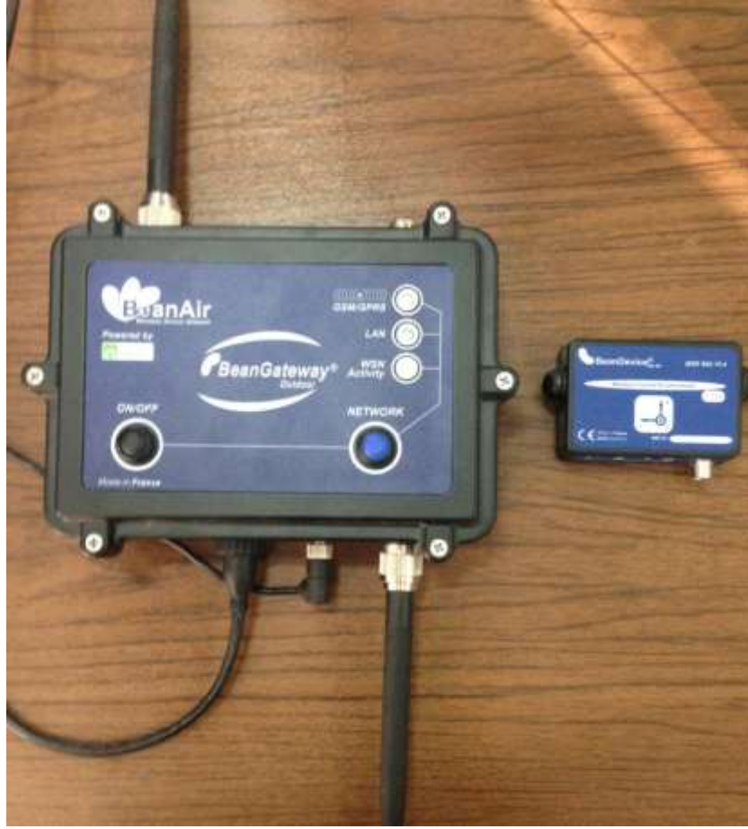
Şekil 3.18. Kablosuz sensör ağı koordinatörü ve kablosuz ivmeölçerin bir görüntüsü
