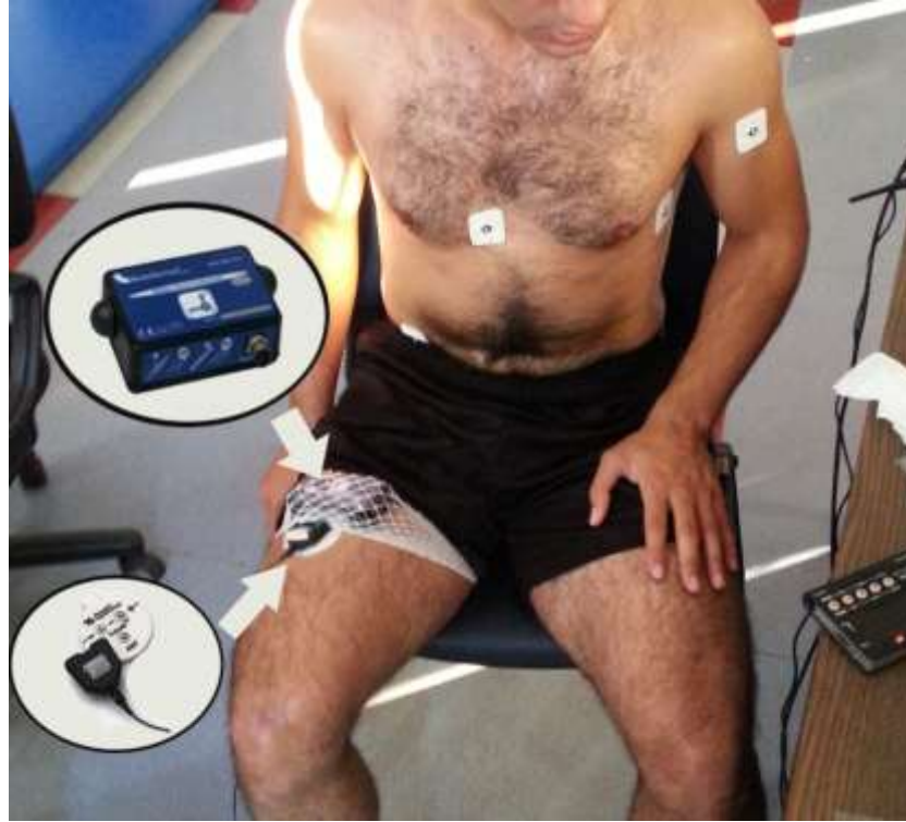
Şekil 3.16. Yüzeysel elektrot ve ivmeölçerin RF kasi üzerine yerleşimi
