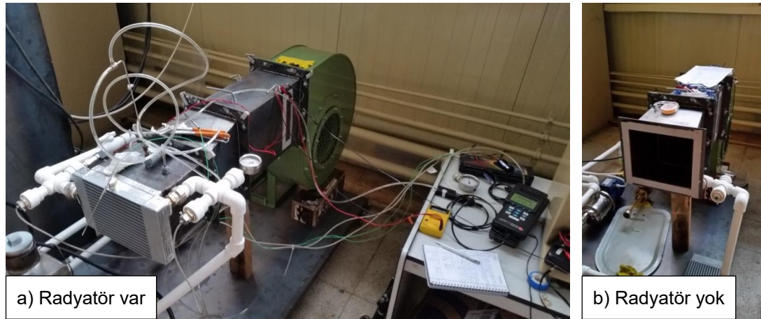
Şekil 3.30. Radyatör varken ve yokken hava hızı ölçümleri
