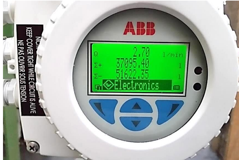
Şekil 3.26. Debimetre testi: 2,70 L/min debide
