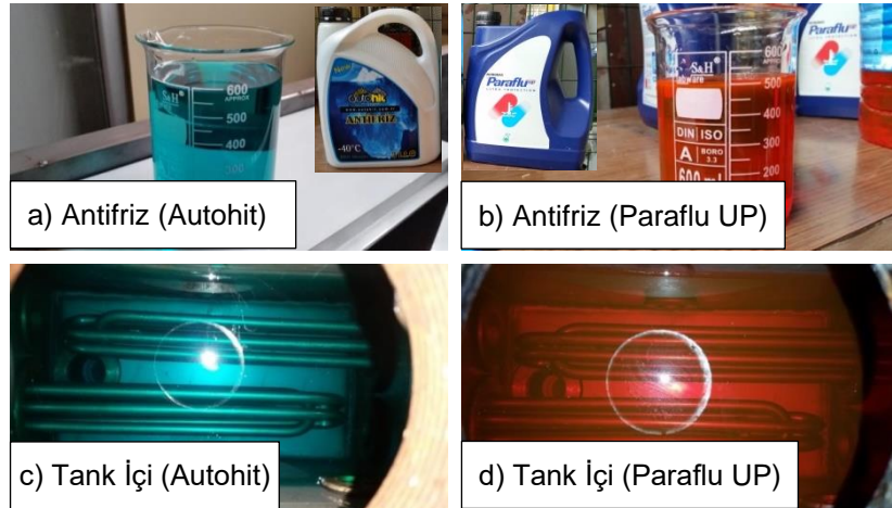
Şekil 3.25. Farklı antifriz kullanımı ve akışkan tankı içinden görünüm
