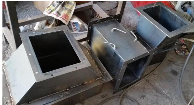
Şekil 3.28. Hava kanalındaki hava klapeleri
