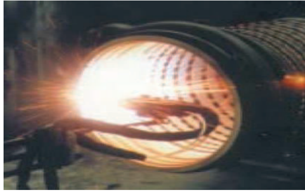
Şekil 3.9. Uçak motorunun tamir amaçlı kaplanma uygulaması [35].
