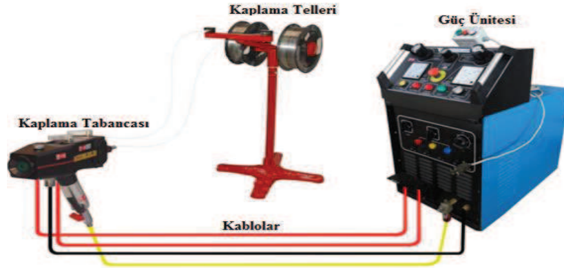
Şekil 3.1. Elektrik ark sisteminin bileşenleri [23].
