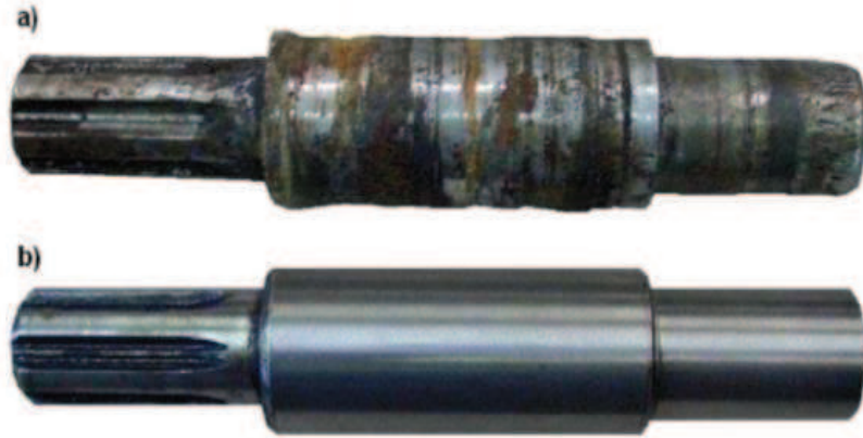
Şekil 3.14. a) İş parçası yüzeyinde kullanım sırasında oluşan aşınma. b) Elektrik ark spreyle kaplanarak tamir edilmiş iş parçası [35].
