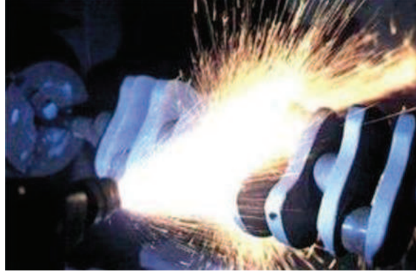
Şekil 3.12. Ark spreyle krank milinin kaplanması [39].
