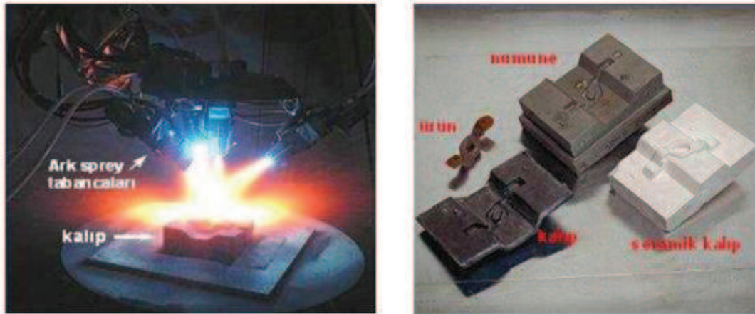
Şekil 3.15. Elektrik ark spreyle hızlı prototip kalıp üretimi ve üretilmiş kalıplar [35].
