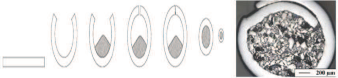
Şekil 4.1. Özlü tel yapımı ve özlü telin tipik karakteristiği [42].
