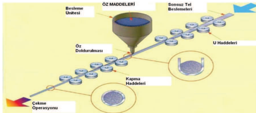
Şekil 4.5. Özlü tel üretiminin şematik gösterimi [42].
