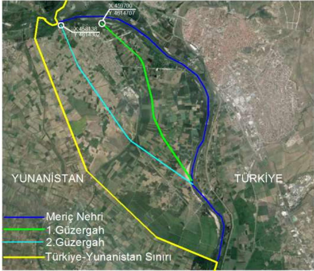
Şekil 5.49. Tahliye kanalları güzergâhları ve başlangıç koordinatları.
