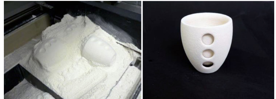
Görsel 6. SLS Yöntemi Üç Boyutlu Yazıcı ile Modellenmiş Vazo (Huson, 2011)
