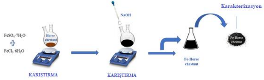
Şekil 5.4. Yabancı kestane dış kabuğuna manyetik özellik kazandırma.
